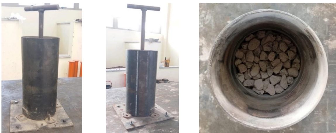
Figura 3.5 - Ensaio de densidade de empacotamento no agregado graúdo.
