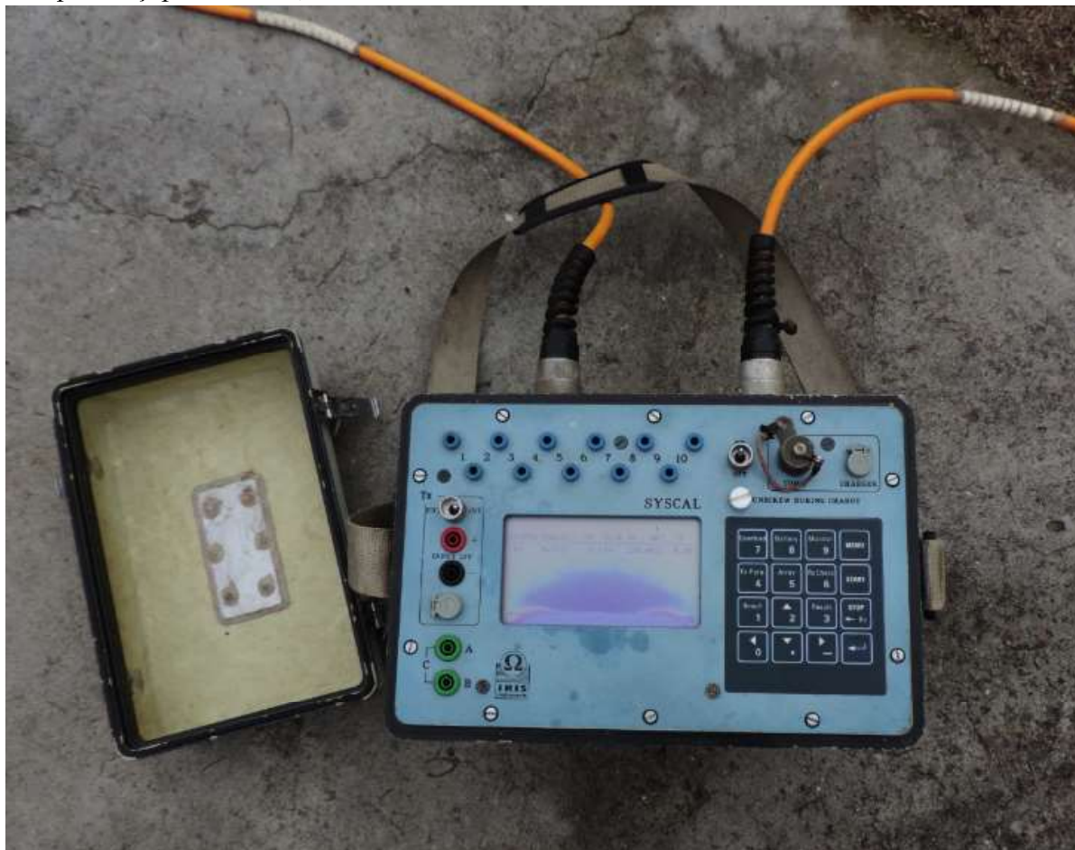
Figura 26 - Resistivímetro elétrico da marca Syscal Pro, com resolução de 1 mV, fabricado na França pela IRIS, de propriedade da Universidade Federal do Pampa (Unipampa), Campus Caçapava do Sul, RS.
