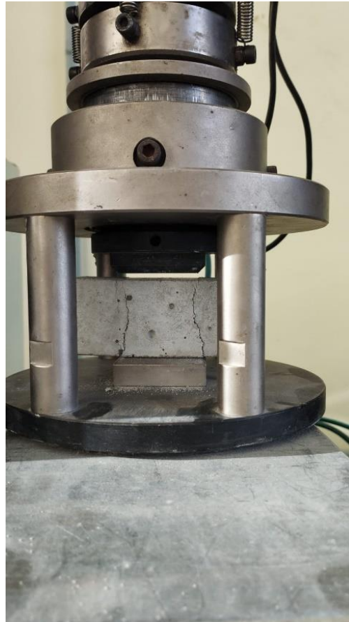
Figura 44: Ensaio de compressão axial da amostra A5 com 0,1% de grafeno
