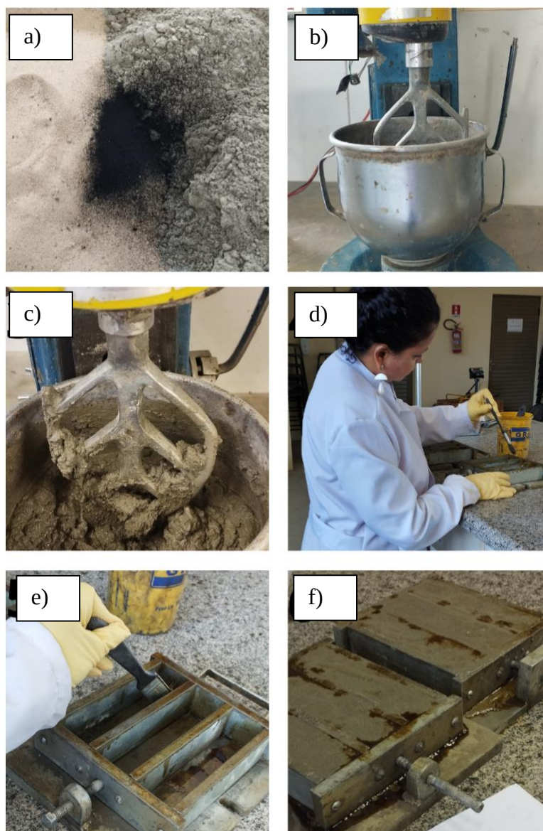
Figura 29: Moldagem dos corpos de prova: (a) dispersão mecânica do grafeno na mistura seca; (b) amassamento na argamassadeira; (c) argamassadeira, (d) aplicação de desmoldante na forma prismática; (e) selando a forma; (f), formas moldadas
