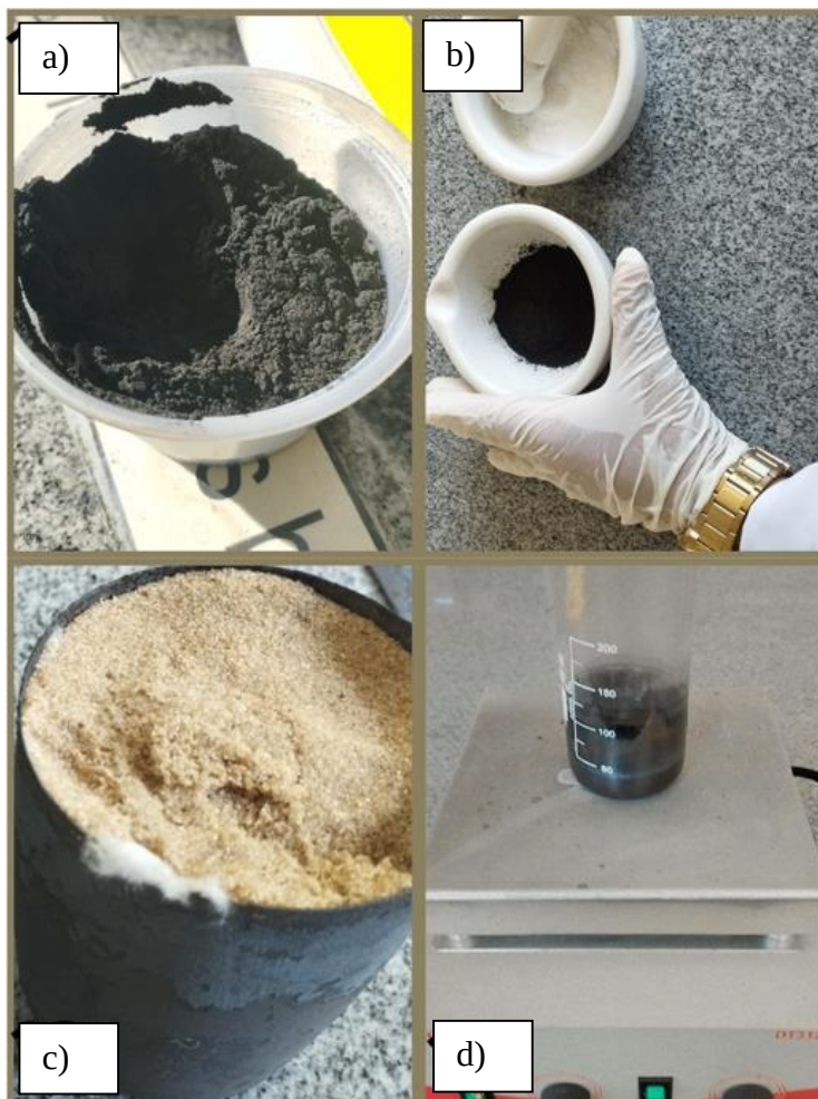
Figura 16: Sintetização do grafeno a partir da CCA. a) cinza da biomassa, b) dosagem aditivo, c) cadinho preparado para ser levado ao forno, d) agitação magnética
