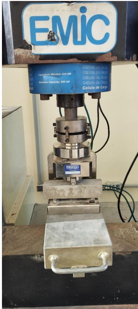
Figura 46: Argamassa A5 sob ensaio de tração a flexão
