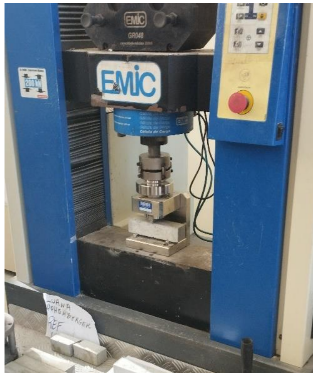
Figura 35: Ensaio de resistência à tração na flexão - amostra de argamassa A2
