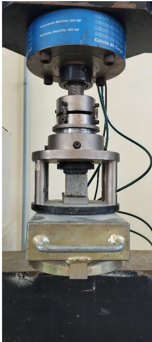
Figura 33: ensaio compressão axial - amostra da argamassa A5
