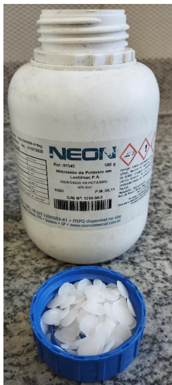
Figura 15: Reagente químico KOH para ativar o grafeno
