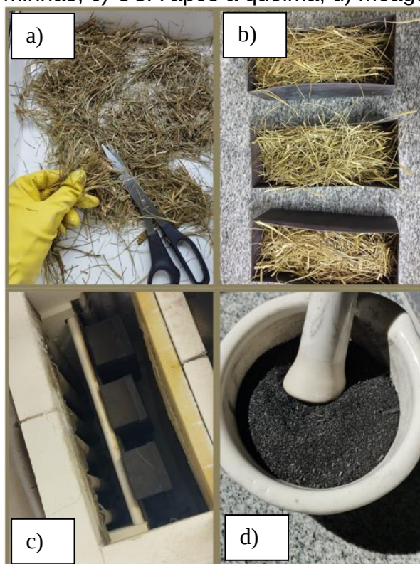
Figura 13: Obtenção da CCA a 400 °C/ 60 min. a) escolha da folha seca; b) folhas secas dentro das forminhas; c) CCA após a queima; d) moagem da CCA
