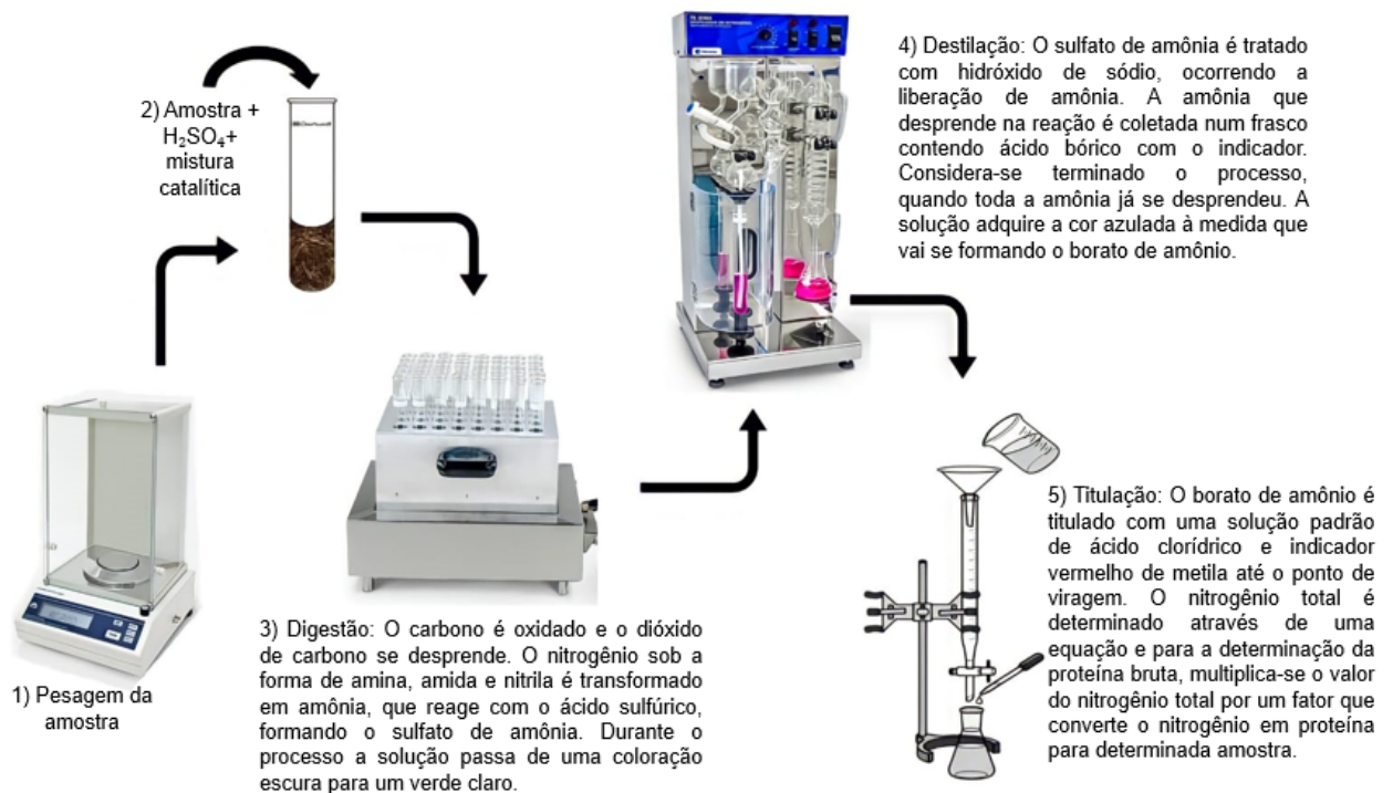
Figura 4 - Esquema do método de Kjeldahl para determinação de nitrogênio, por etapas.
