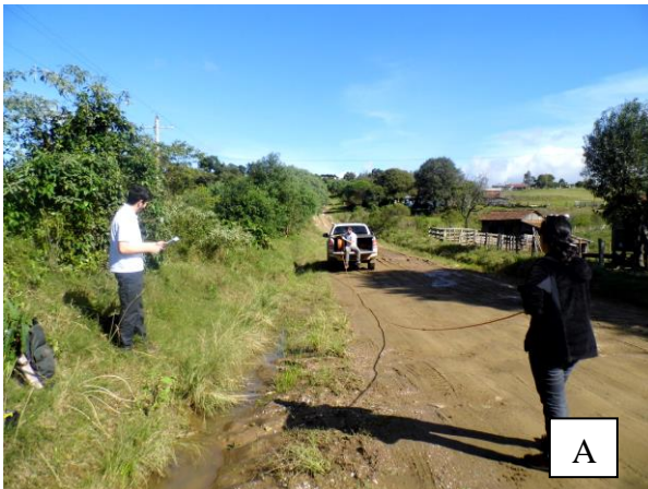
Figura 13 – Cabeamento utilizado para a aquisição de dados. A) Disposição dos cabos em campo; B) Exemplo da colocação de eletrodos.
