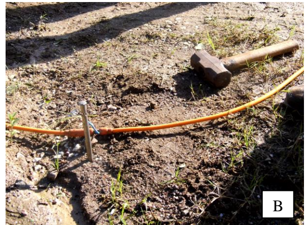
Figura 13 – Cabeamento utilizado para a aquisição de dados. A) Disposição dos cabos em campo; B) Exemplo da colocação de eletrodos.
