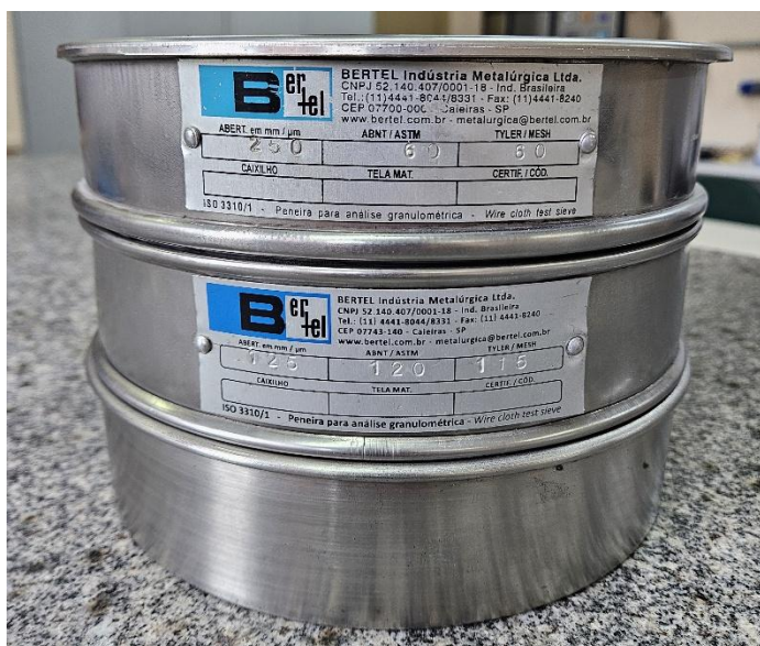
Figura 6 - Conjunto de peneiramento utilizado para separação dos fragmentos que foram utilizados para produção de microesferas.
