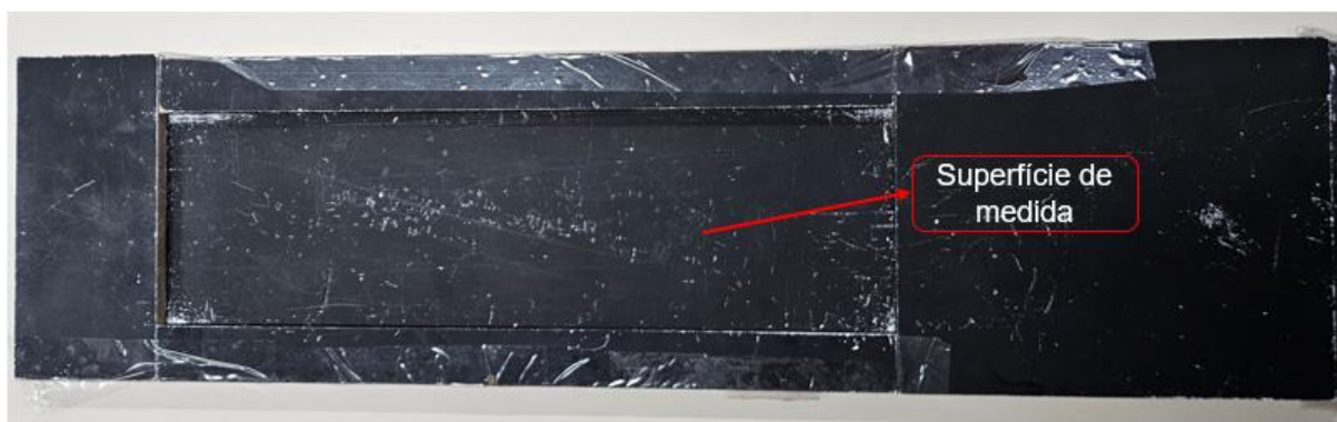
Figura 17 - Placa de MDF utilizada para análises de retrorrefletividade.
