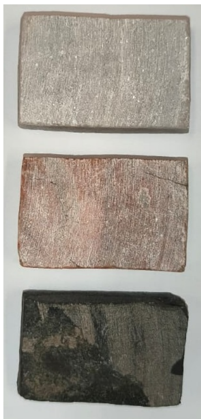
Figura 4: Amostras utilizadas para a confecção das lâminas. Topo: mármore branco. Meio: mármore rosa. Base: diabásio. Fonte: Autoria Própria.
