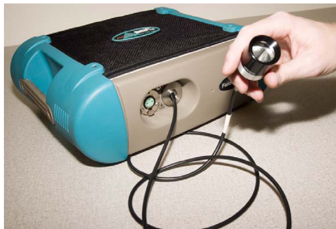
Figura 5: Espectrorradiômetro hiperespectral FieldSpec® 3. Fonte: Manual do Equipamento.
