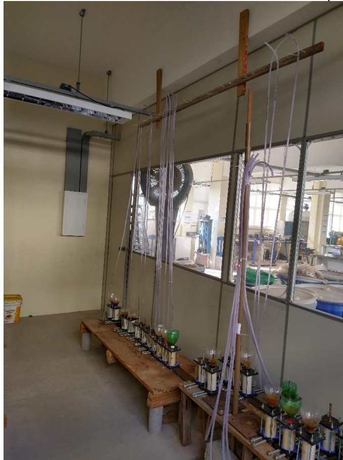
Figura 28: Permeômetros em sala climatizada durante o ensaio de permeabilidade.
