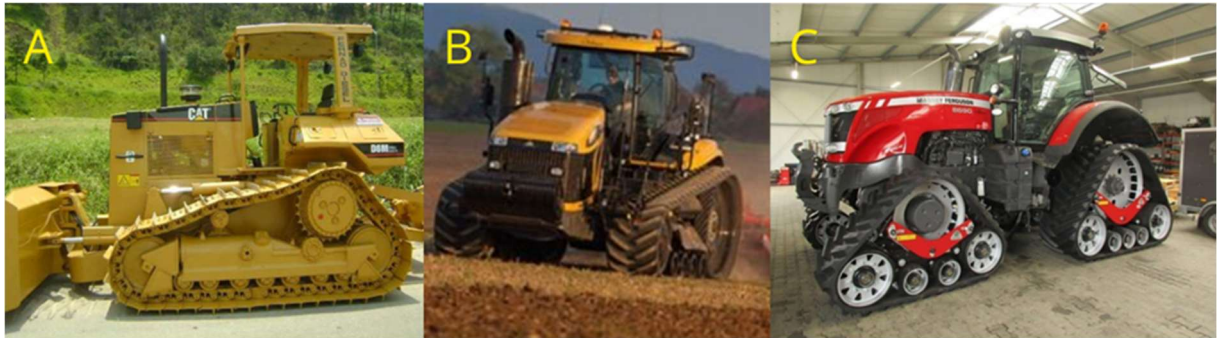
Figura 1 - Exemplo de tratores com rodado de esteira. (A: Esteira metálica, B: Esteira de borracha e C: Semiesteira).
