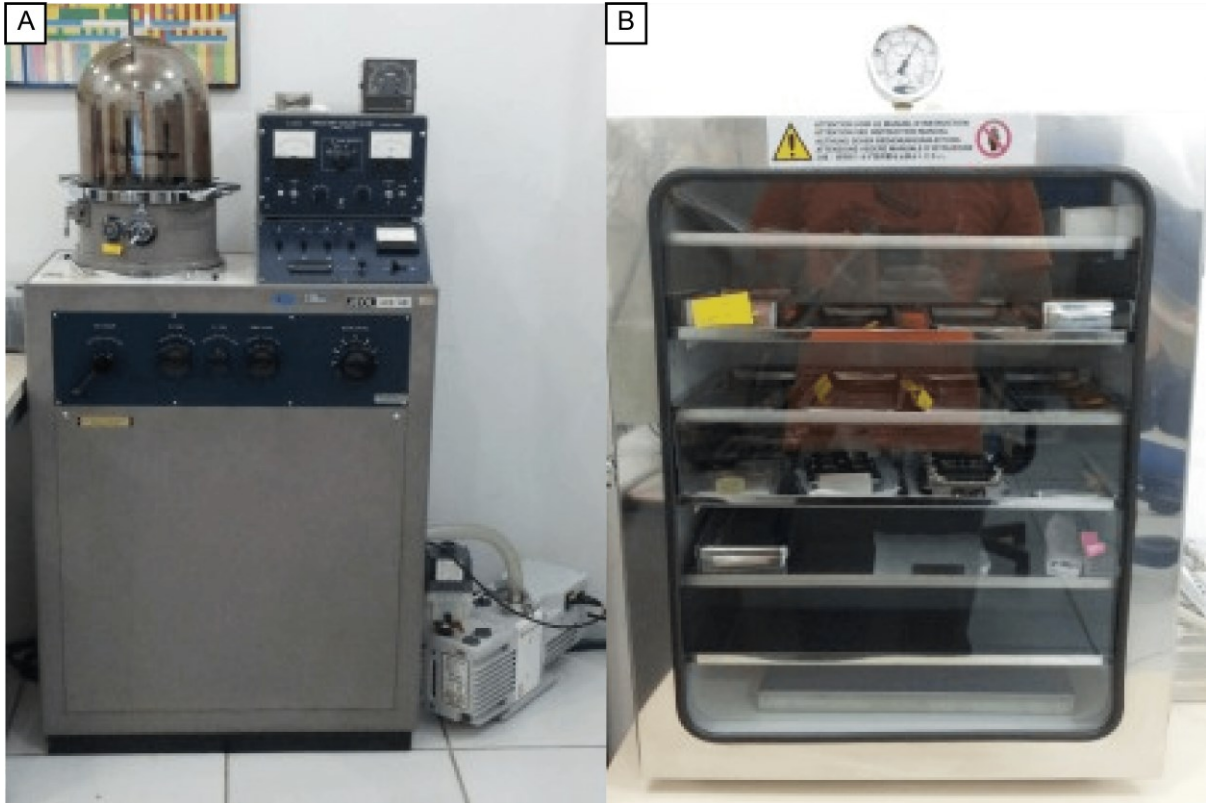
Figura 23 – Equipamentos utilizados para o processo de metalização das lâminas. A) Metalizadora Jeol JEE 4B; B) Armário dessecador com sistema de vácuo.
