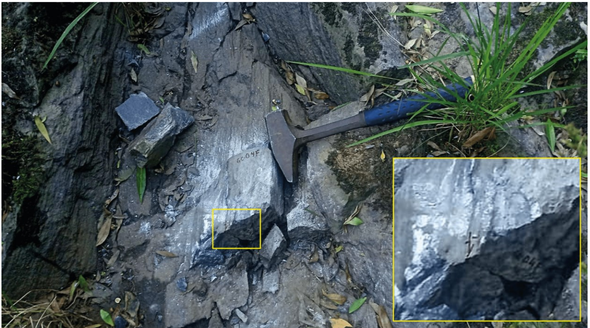
Figura 14 – Amostra GC-04F, coletada e orientada no próprio local de amostragem, zoom de onde foi realizada a orientação da amostra.
