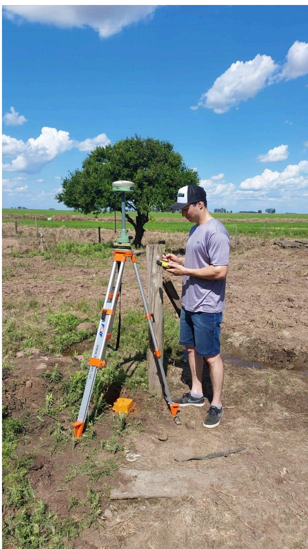
Figura 15: Coleta do ponto inicial, através do RTK
