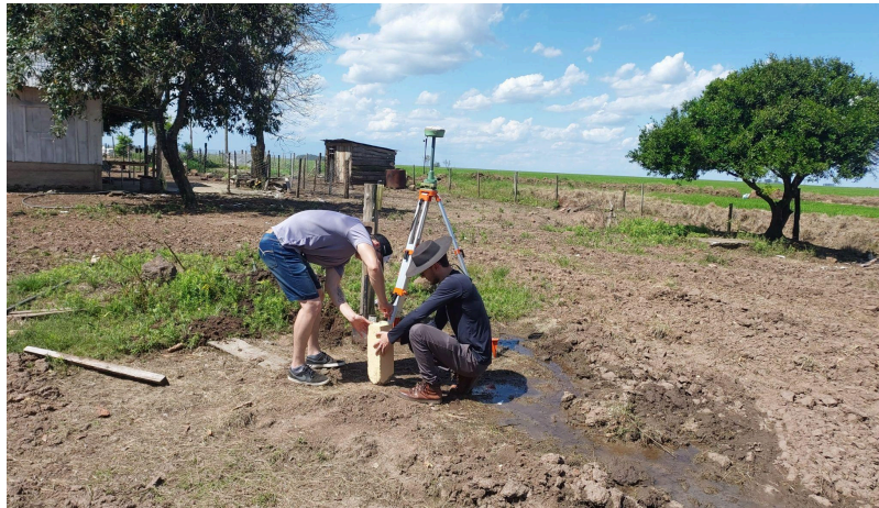
Figura 12: Fixação do parafuso acima do marco
