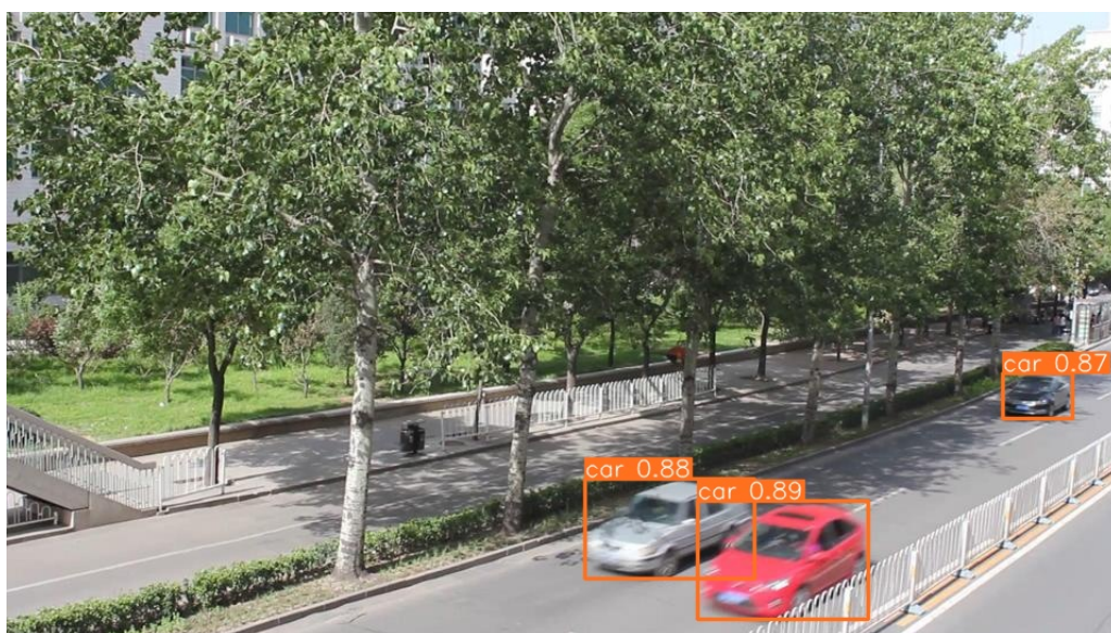
Figura 16 – Exemplo de detecção de veículos utilizando o YOLOv8.
