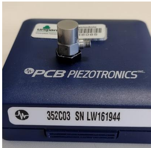
Figura 14 – Exemplo de acelerômetro utilizado nos ensaios de EA
