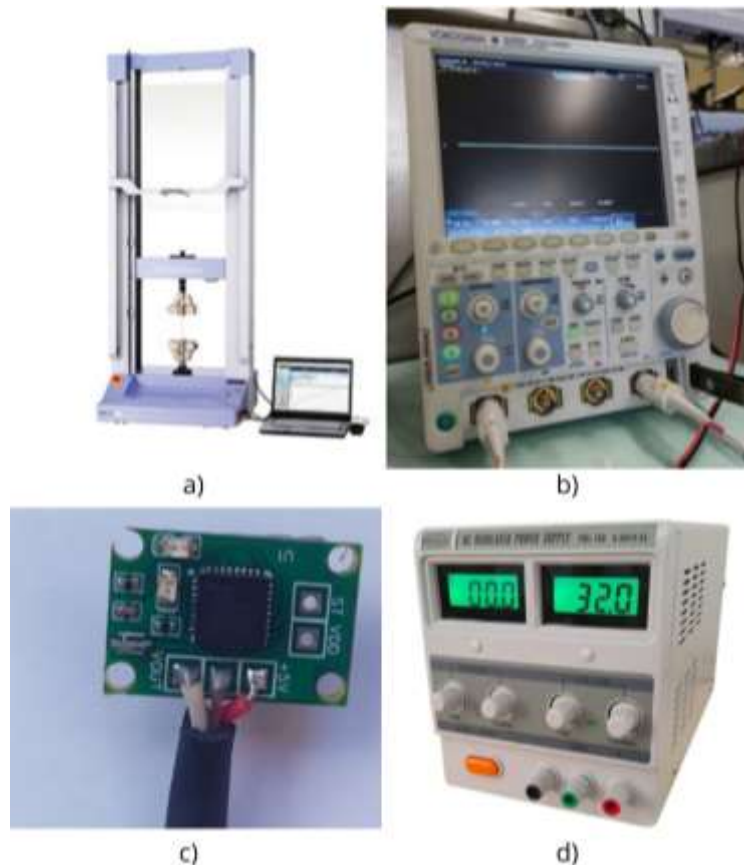
Figura 8 – (a) Máquina de ensaio, (b) osciloscópio Yokogawa, (c) Sensor MEMS utilizado durante os ensaios e (d) fonte.
