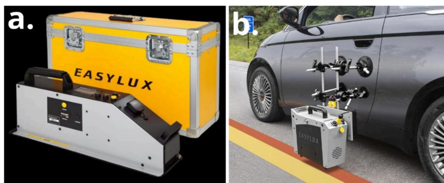
Fonte: Adaptado Easylux Retroreflectometer
