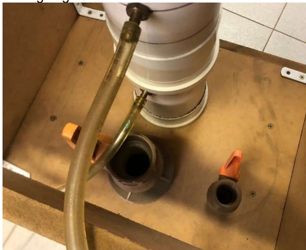
Figura 7 - Válvulas de Regulagem Pressão de Referência e Pontos de tomada de pressão.
