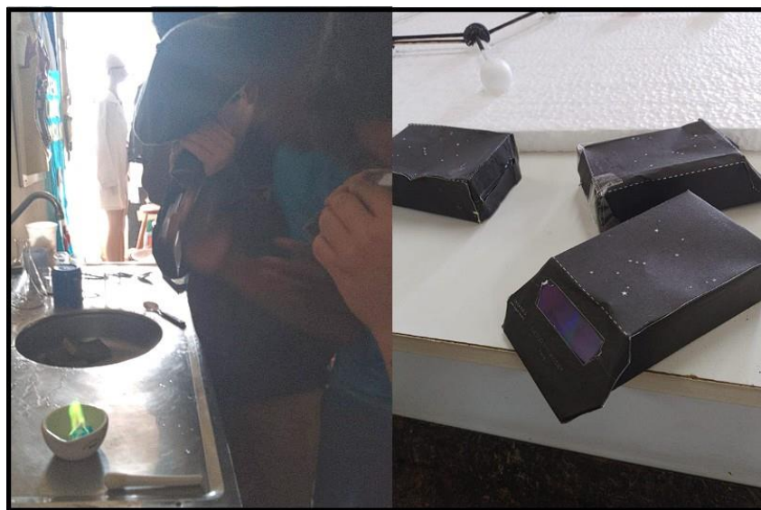
Figura 14: Utilizando o espectroscópio caseiro, no teste de chamas
