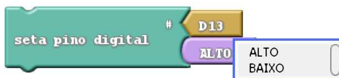
Figura 53– Como utilizar um pino digital para alimentação.
