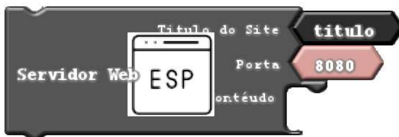
Figura 116 – Bloco de servidor web
