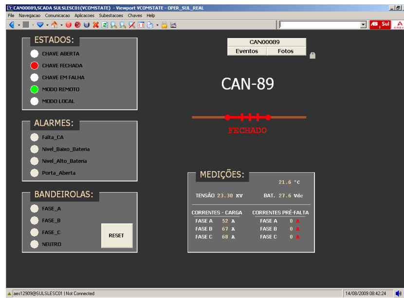
Figura 5 – Tela de monitoramento e comando de uma chave telecomandada da AES SUL.
