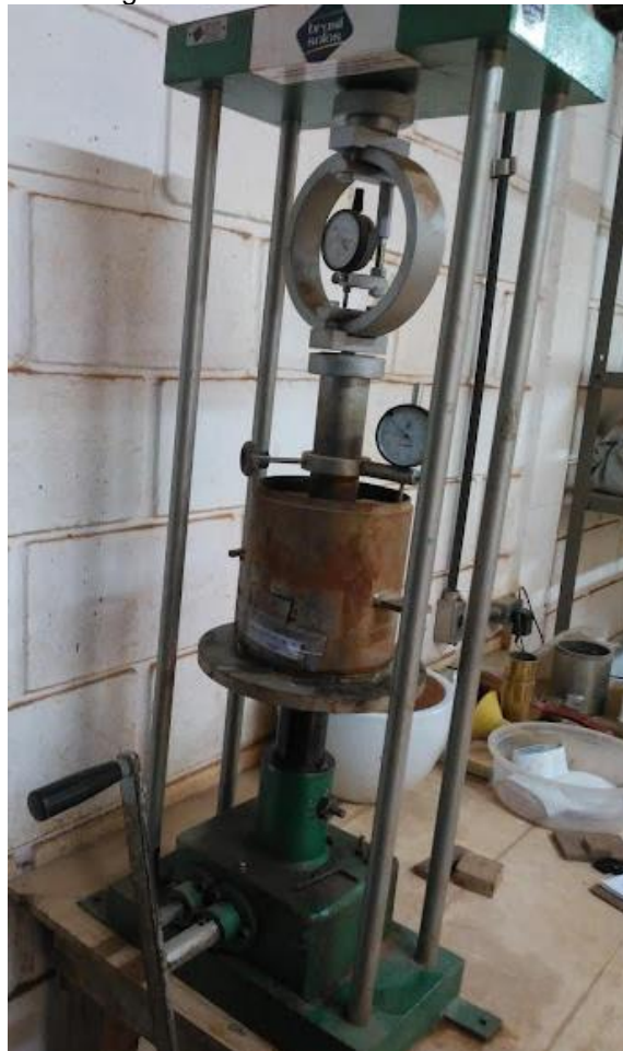
Figura 42 - Prensa de ensaio CBR
