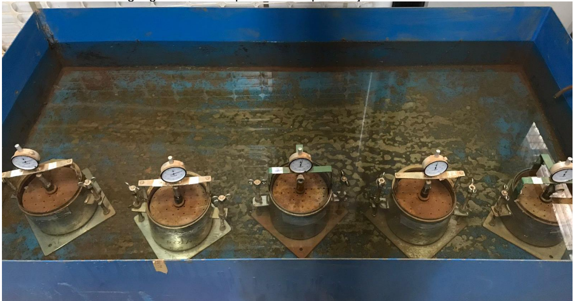
Figura 41 - Execução ensaio CBR, mostra amostras de solo submersas em um tanque de água, com dial gauges instalados para medir a penetração durante o teste.
