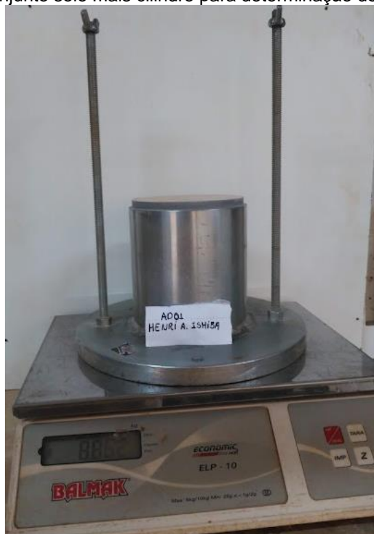
Figura 39 - Pesagem de conjunto solo mais cilindro para determinação do índice de vazios mínimo.
