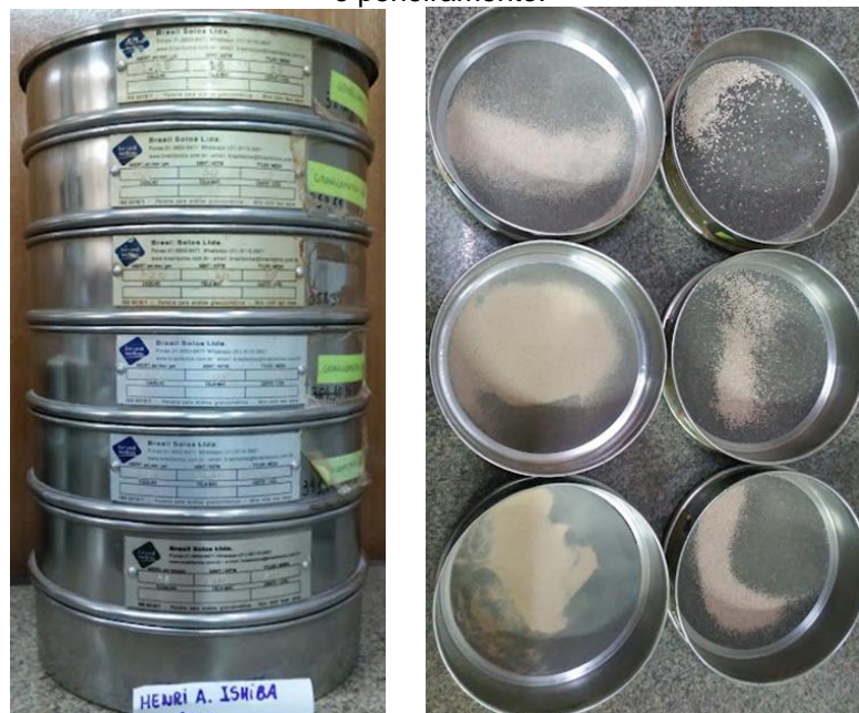
Figura 33 - A esquerda conjunto de peneira para análise granulométrica, a direita material retido após o peneiramento.
