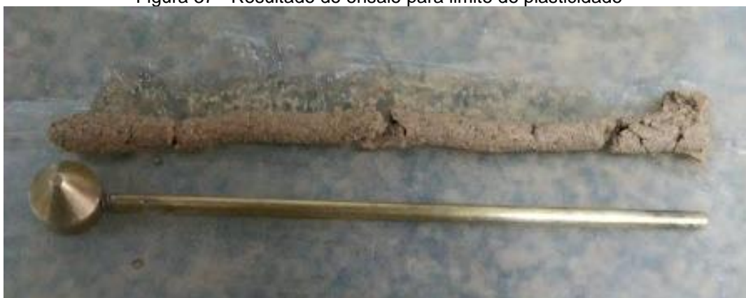
Figura 37 - Resultado do ensaio para limite de plasticidade
