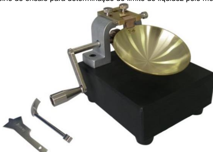
Figura 36 - Aparelho de ensaio para determinação do limite de liquidez pelo método Casa Grande
