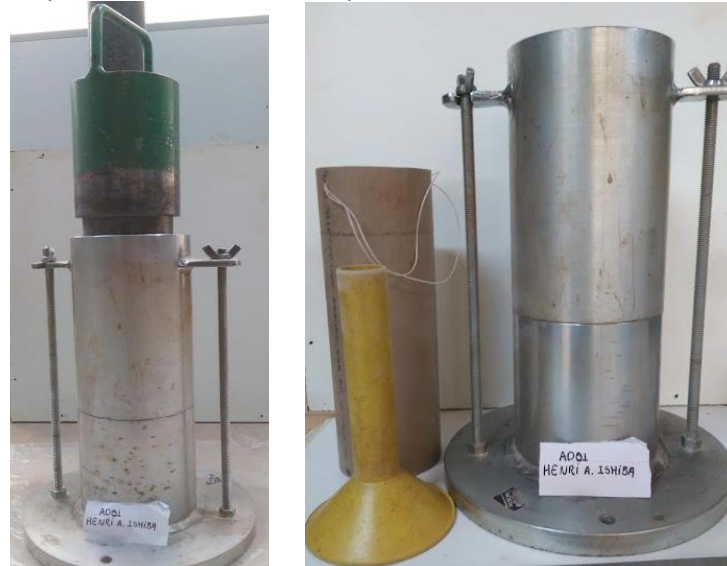
Figura 38 - Recipiente preenchido com material para o, ensaio de índice de vazios mínimo e máximo
