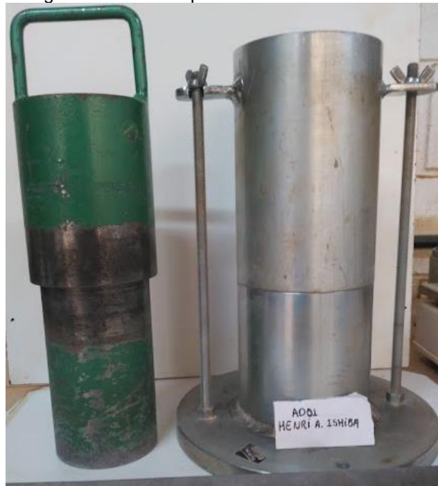
Figura 40 - Cilindro para ensaio Proctor Normal.
