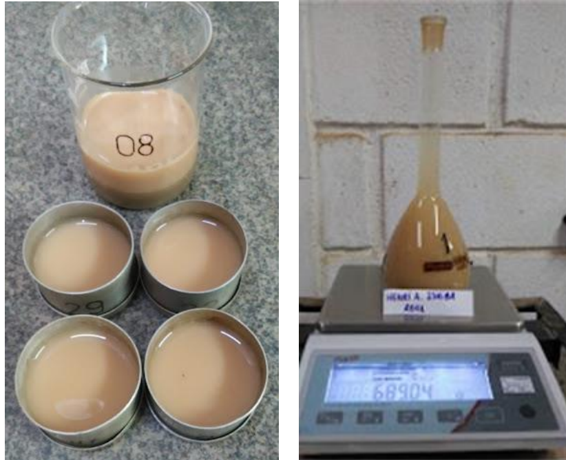
Figura 35 - A esquerda preparação da amostra para os ensaios de massa específica real dos grãos (MER), a direita execução do ensaio de massa específica real dos
