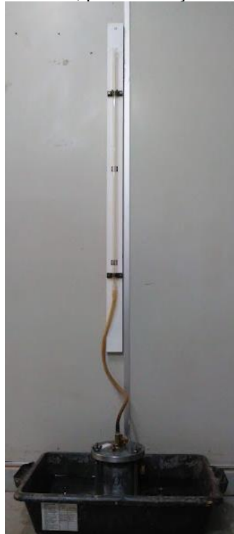
Figura 43 - Permeâmetro de carga variável, para execução de ensaio de permeabilidade do solo.
