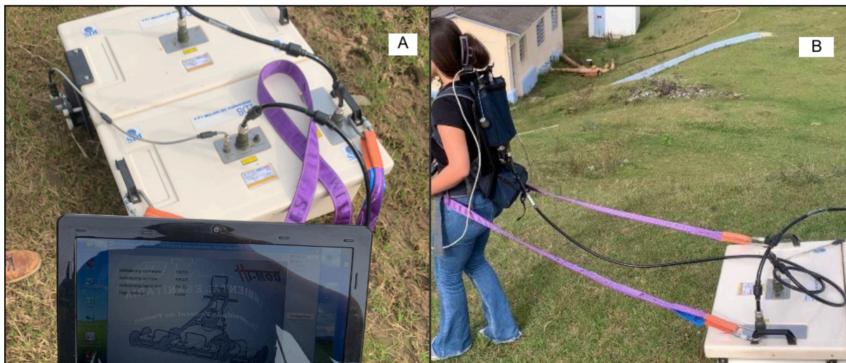
Figura 17 - (A) Equipamento IDS Instruments, (B) Funcionamento do Georadar
