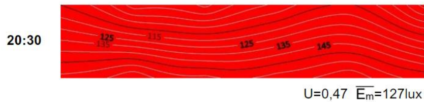
Figura 41– Curvas isolux do quadro da sala 205, somente com a luz artificial no período noturno.
