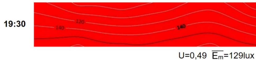
Figura 31– Curvas isolux do quadro da sala 205, somente com a luz artificial no período noturno.
