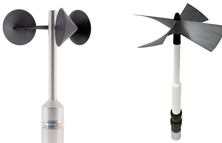
Figura 6: a) Anemômetro de Conchas. b) Anemômetro de Hélices.
