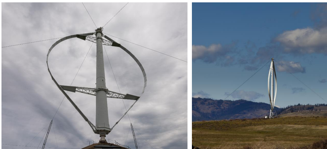
Figura 20: a) Turbina Eólica Darrieus em Central Wahington. b) Vista lateral da turbina.
