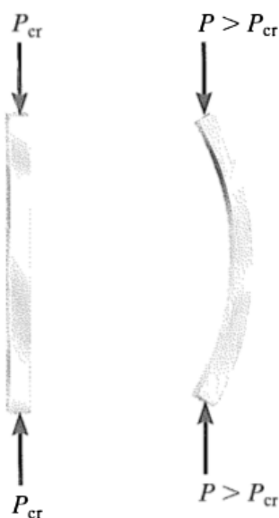
Figura 2.6: Ilustração de uma viga sobre flambagem.
