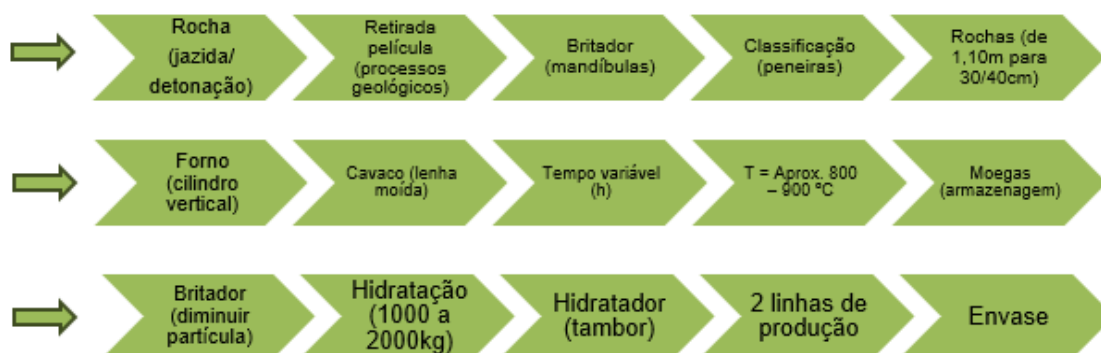
Figura 13 – Esquema do processo de produção da cal hidratada.
