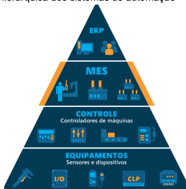
Figura 3 – Estrutura hierárquica dos sistemas de automação
