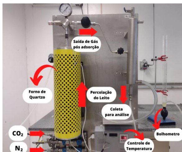
Figura 12 - Reator tubular com coluna de quartzo.
