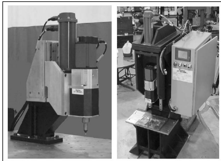
Figura 12 – Máquina de solda ponto por fricção, desenvolvida pela Friction Stir Link
