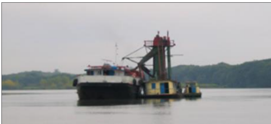
Figura 8 – Draga alcatruz em carregamento de barco tipo “chata”.
