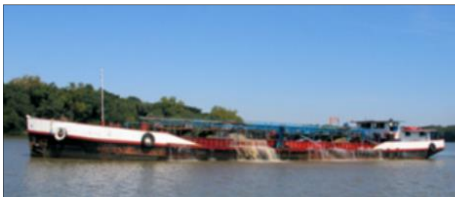
Figura 9 – Draga de sucção autopropulsada em atividade.
