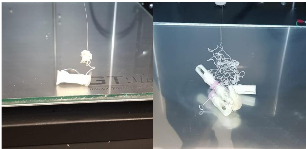
Figura 29 Exemplo de erro de impressão com um objeto na foto da esquerda e com vários objetos na foto da direita.
