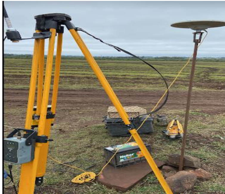
Figura 5: Base RTK para o PPK e para pesquisa terrestre.
