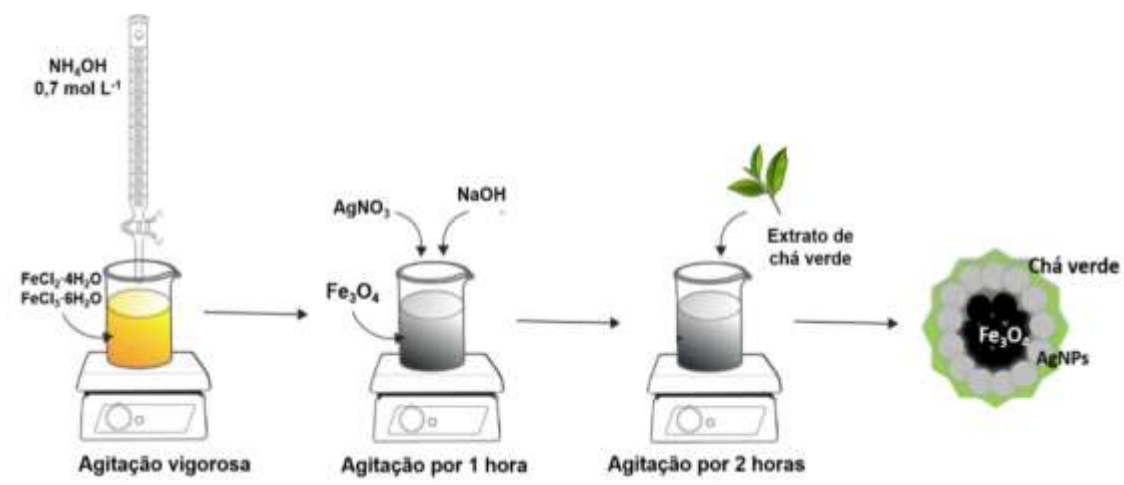
Figura 2. Esquema de síntese de \text{Fe}_3\text{O}_4@ Ag-NPs (PIERETTI et al. , 2019).
