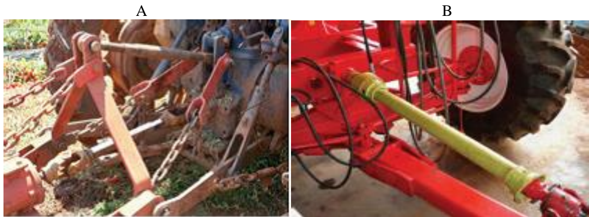
Figura 1 - Apresentação de equipamento com árvore cardan exposta (A) e com proteção (B).
