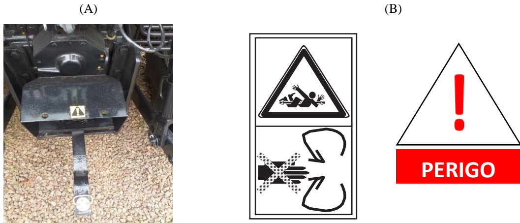
Figura 19 - Pictograma de alerta sobre risco de contato com a TDP (A) e padrão normativo de pictogramas para essa finalidade (B)
