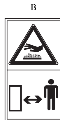
Figura 9 - Registro de alerta devido ao risco de contato com superfície quente (A) e padrão de painel recomendado pela norma (B)
