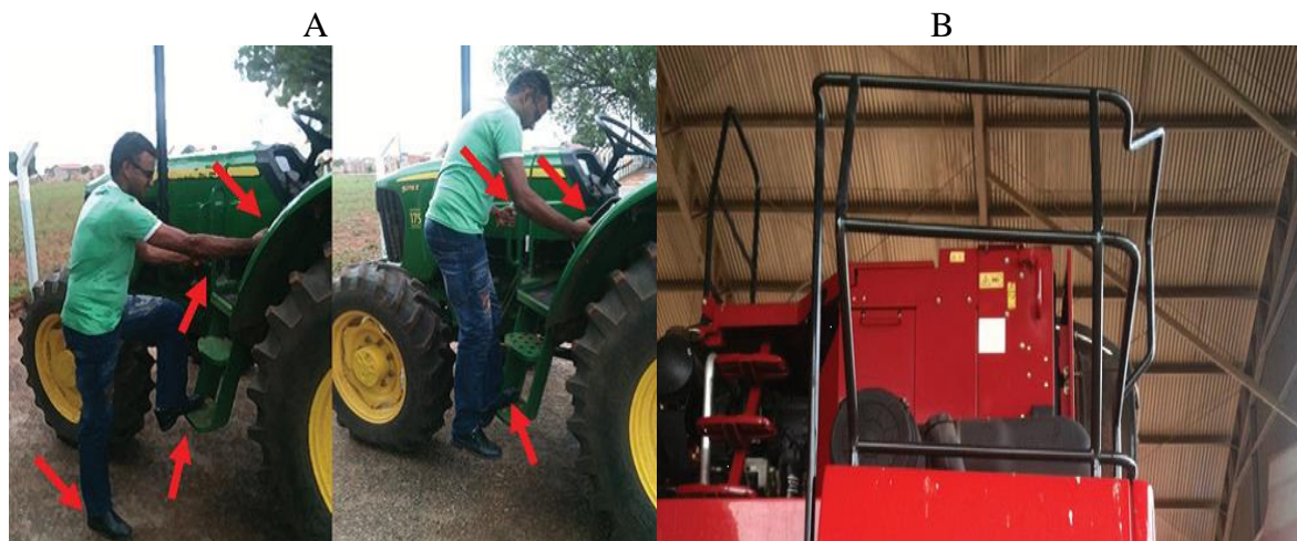
Figura 3 - Escada com pontos de apoio (A) e plataforma com proteção contra quedas (B).
