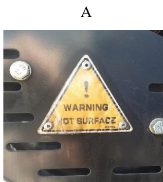
Figura 9 - Registro de alerta devido ao risco de contato com superfície quente (A) e padrão de painel recomendado pela norma (B)
