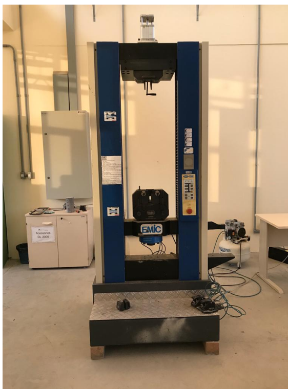
Figura 12 – Prensa de ensaio universal EMIC
