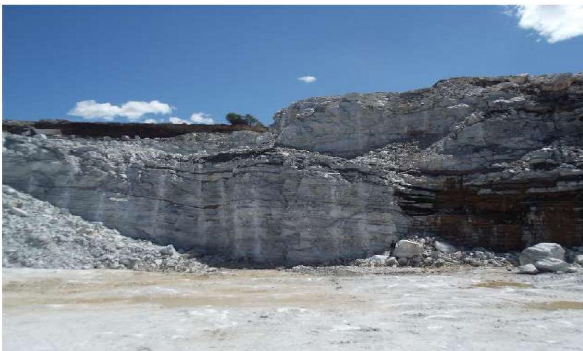
Figura 31 Mármore com faturamento entre camadas.
