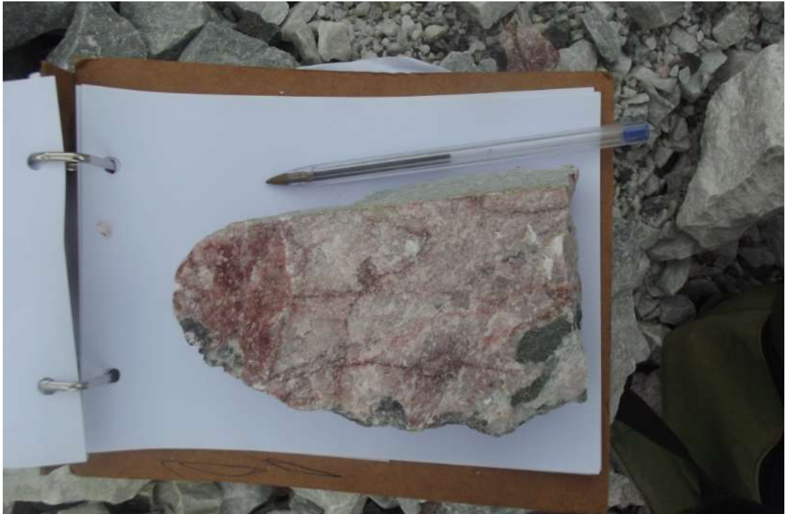
Figura 6 Mármore com presença de hematita.
