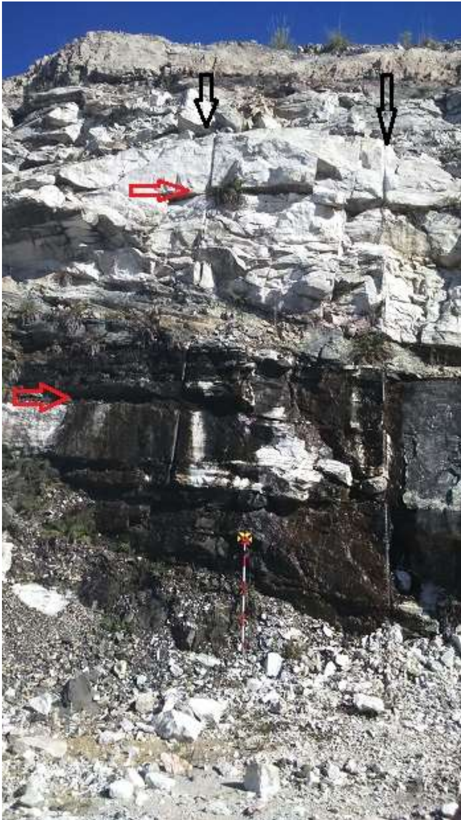
Figura 17 Comportamento das estruturas no mármore, setas pretas indicando fraturamentos vertical e as setas vermelhas indicando fraturas sub horizontais no mármore e camadas diabásio.
