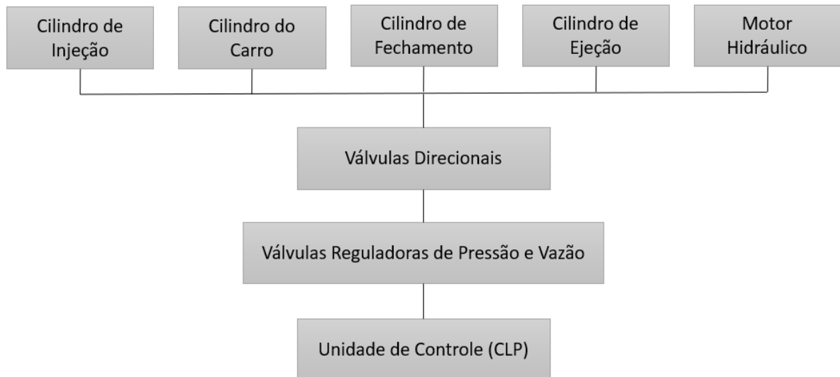
Figura 15 - Diagrama básico do sistema hidráulico da máquina
