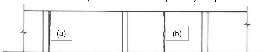
Figura 7 – Fissuras verticais: a) Entre alvenaria e pilar; b) Corpo da alvenaria
