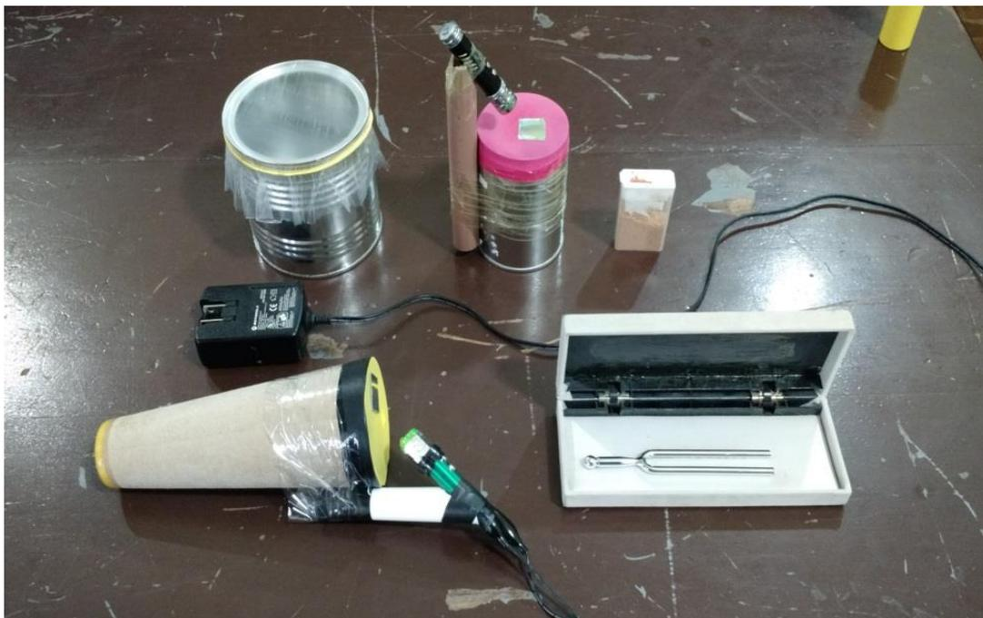
Figura 6: Aparatos experimentais construídos e diapasão: materiais utilizados para realizar as demonstrações experimentais.
