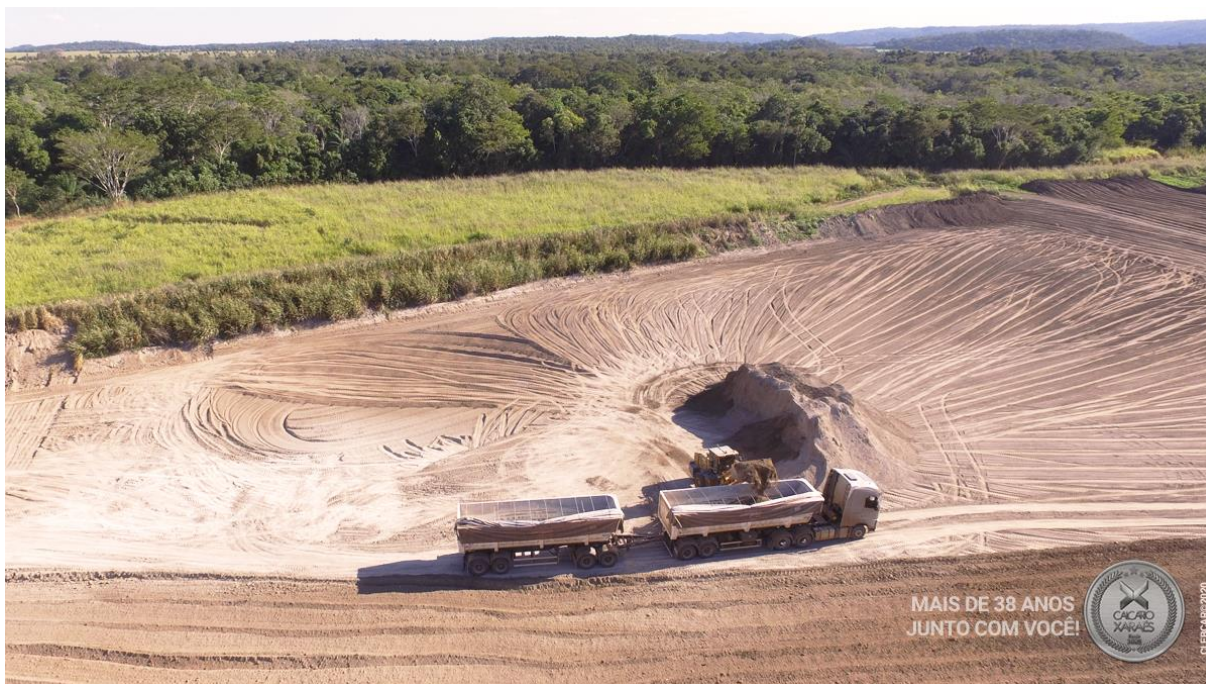
Figura 14 – Mineração pelo método de aragem na empresa Calcário Xaraés.
