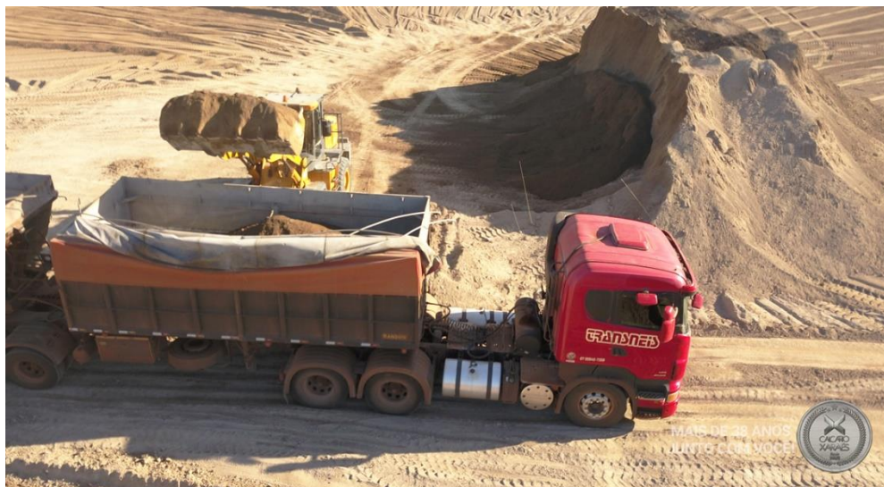
Figura 20 – Exploração das tufas calcárias pelo método de aragem, não exige operações complexas.
