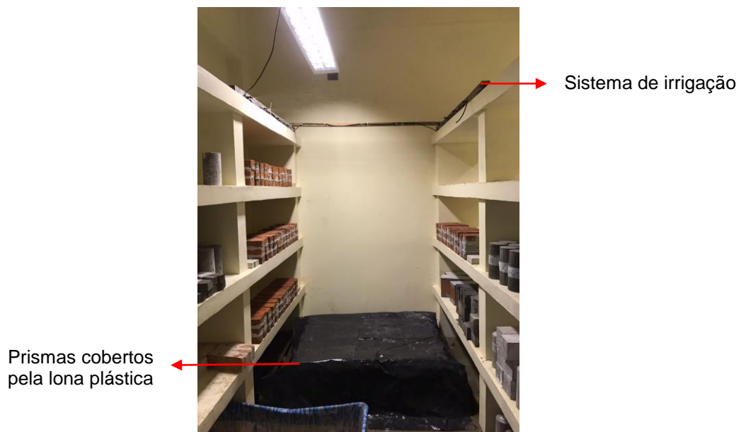
Figura 14 – Prismas de argamassas e de tijolos cerâmicos maciços acondicionados na câmara úmida
