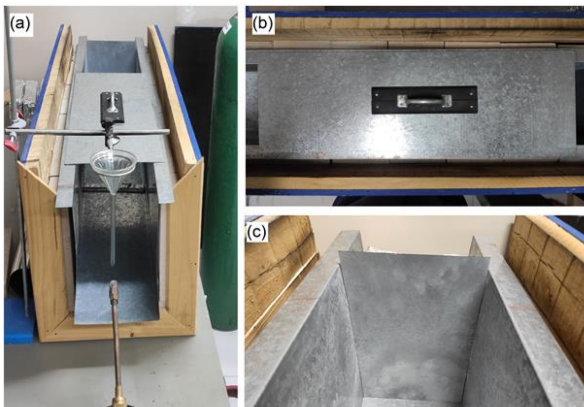
Figura 30 – Equipamento utilizado(a); Chapas de aço para evitar perdas de microesferas (b e c).
