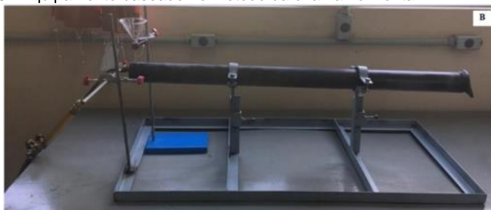
Figura 16 - Equipamento baseado no método da chama horizontal.
