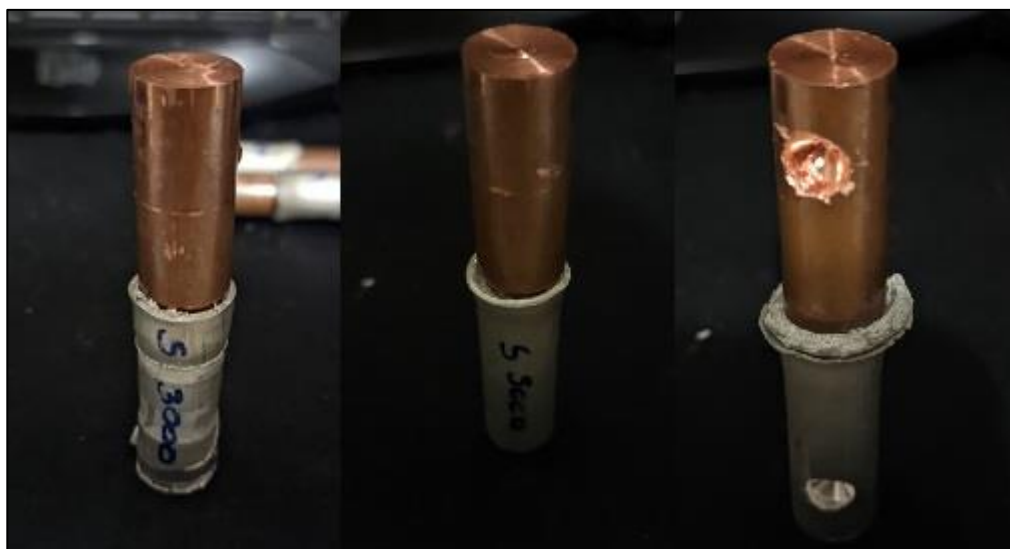
Figura 29: Corpos de prova caso 1 soldados em detalhe a 3000, 5000 e 7000 RPM.
