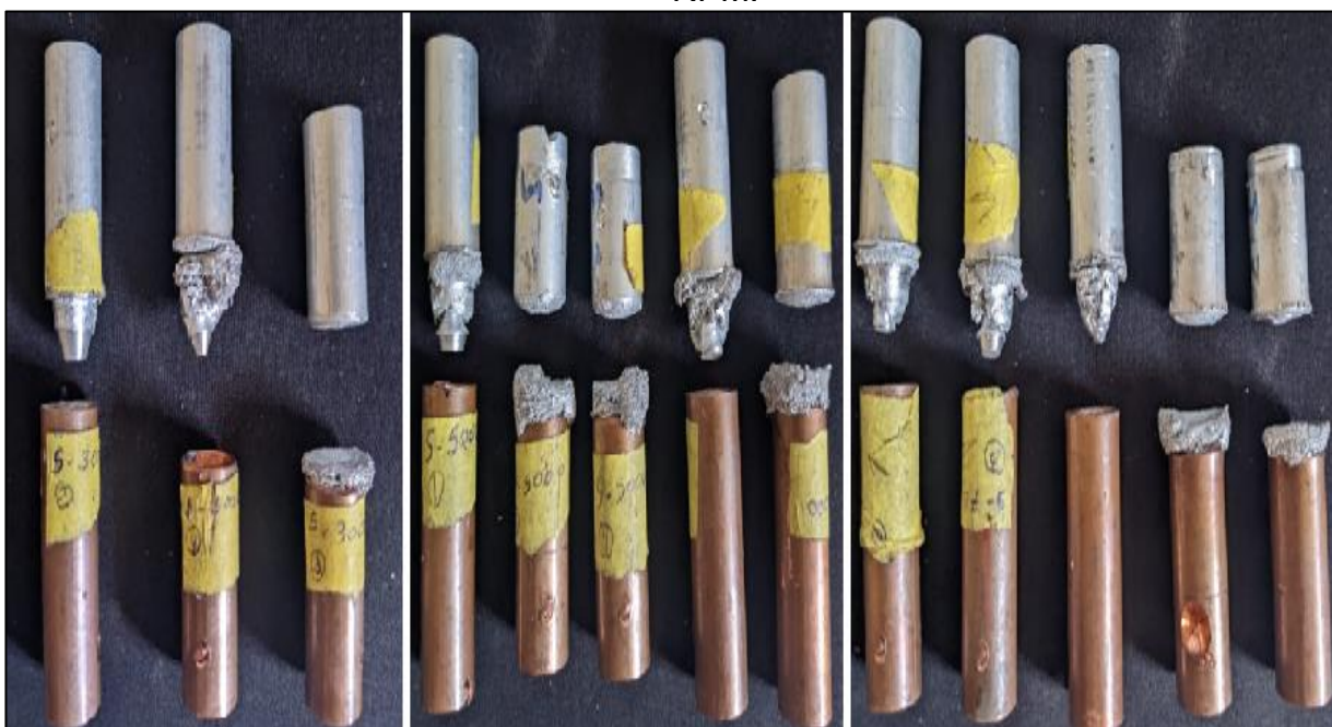
Figura 34: Corpos de prova rompidos caso 2 em detalhe a 3000, 5000 e 7000 RPM.
