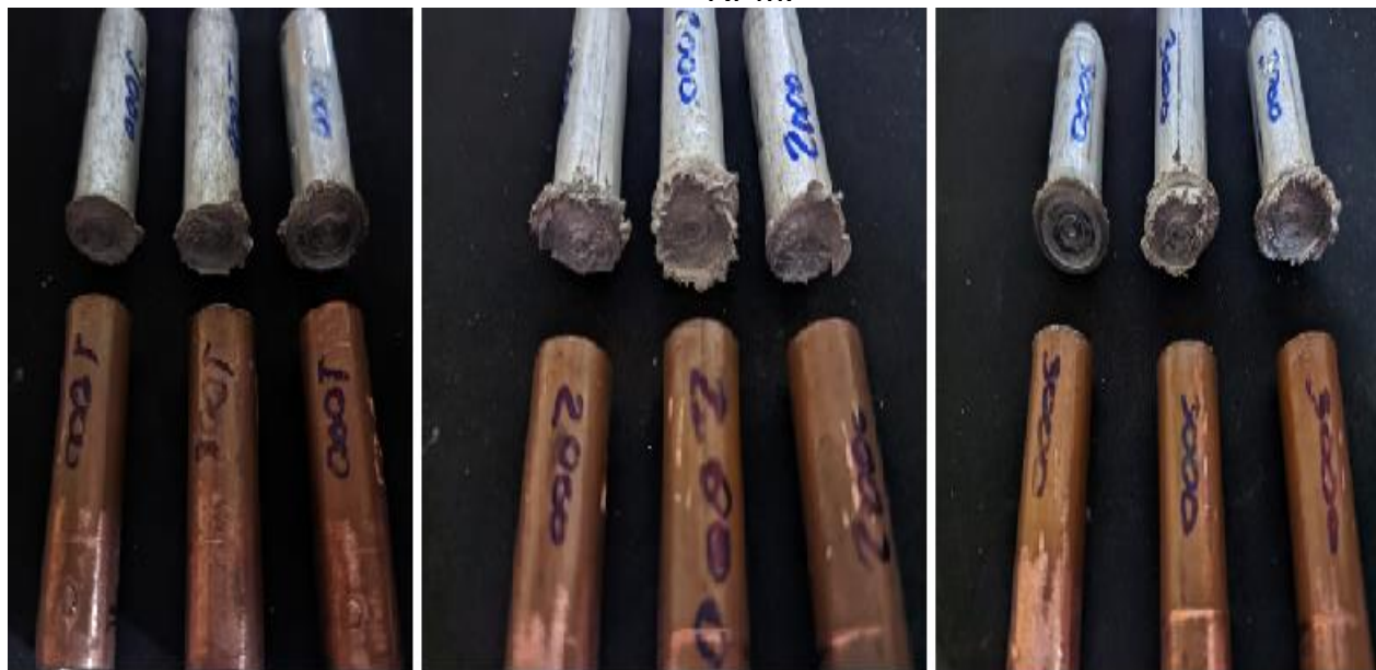
Figura 37: Corpos de prova rompidos caso 3 em detalhe a 1000, 2000 e 3000 RPM.
