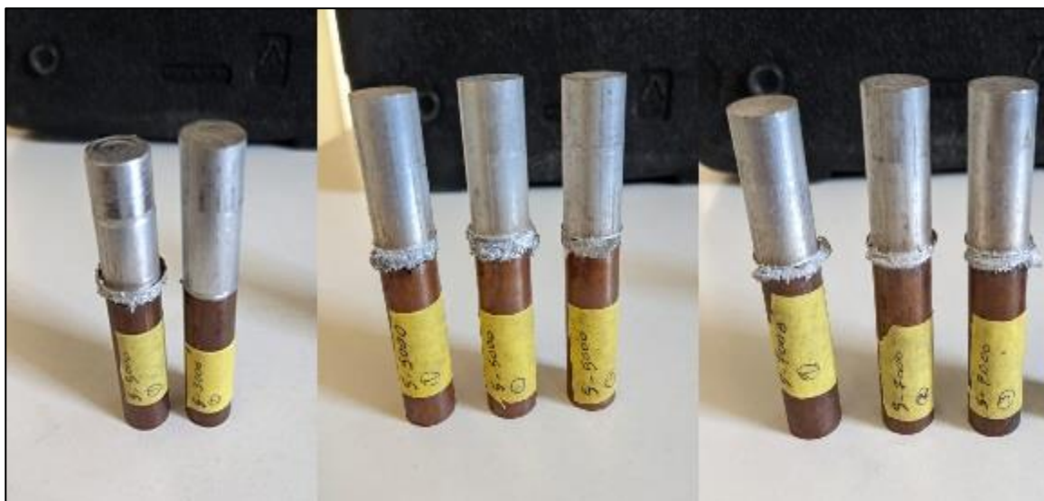
Figura 30: Corpos de prova soldados caso 2 em detalhe a 3000, 5000 e 7000 RPM.
