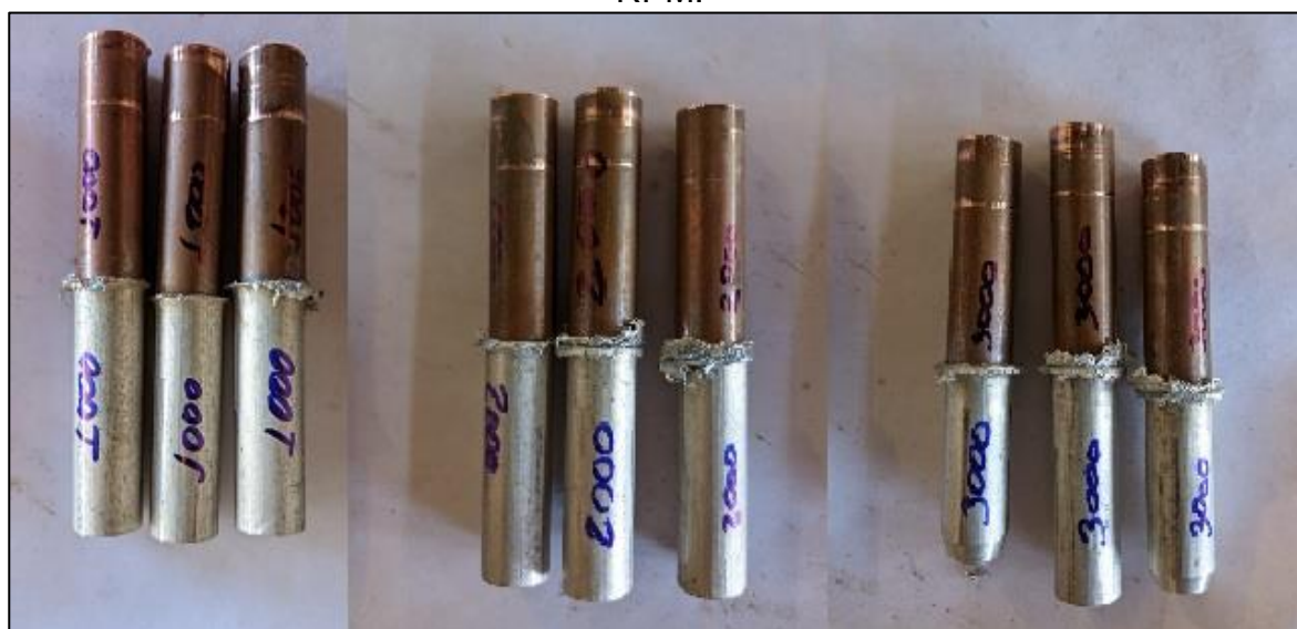
Figura 31: Corpos de prova soldados caso 3 em detalhe a 1000, 2000 e 3000 RPM.
