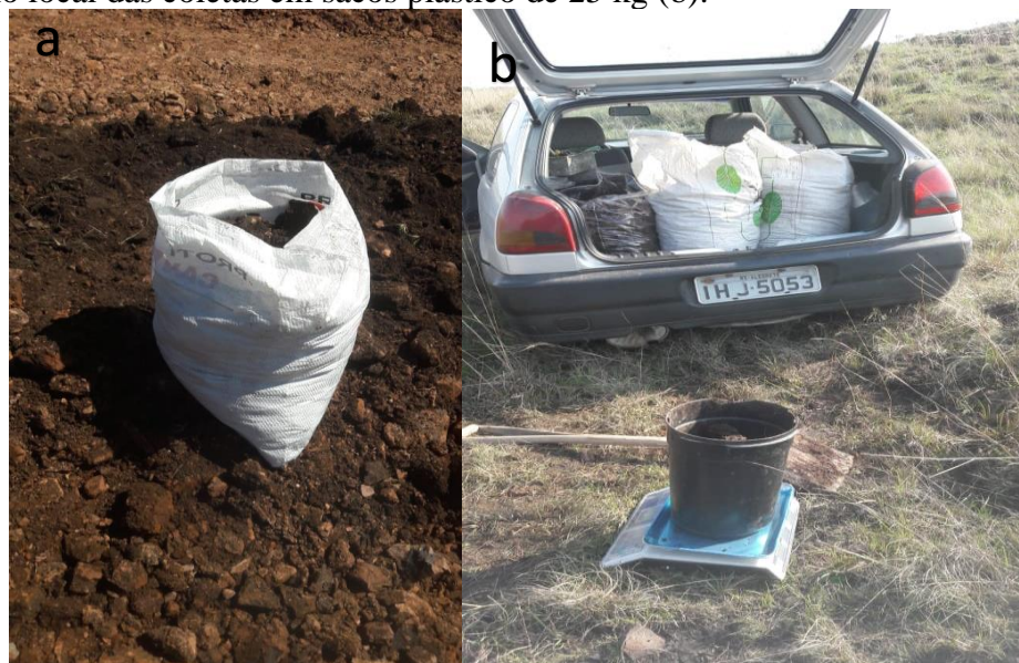
Figura 39 – Coletas das amostras no maciço da barragem (a), pesagem e acondicionamento das amostras no local das coletas em sacos plástico de 25 kg (b).
