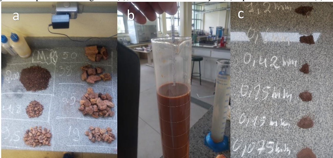
Figura 41 – peneiramento grosso (a), ensaio de sedimentação (b) e peneiramento fino (c).
