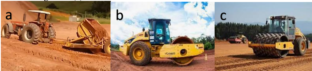
Figura 11 – Equipamentos utilizados na compactação em solos siltosos (a), em solos arenosos (b) e em solos argilosos (c).
