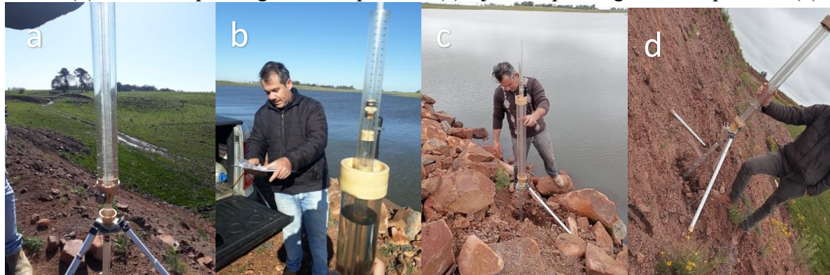
Figura 51 – Instalação do equipamento (a), anotações das leituras realizadas “região do núcleo” (b), montante para região dos espaldares (c) e jusante para região dos espaldares (d).
