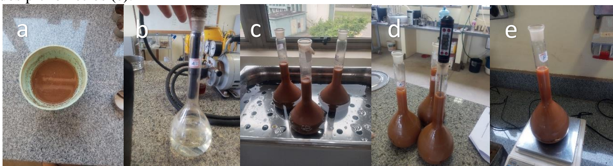
Figura 43 – Material em repouso com defloculante (a), vácuo dos picnômetros (b), banho maria dos picnômetros (c), calibração da temperatura dos picnômetros (d) e determinação das massas dos picnômetros (e).
