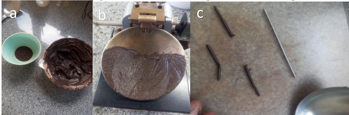
Figura 42 – Amostras homogeneizadas (a), limite de liquidez (b) e limite de plasticidade (c).
