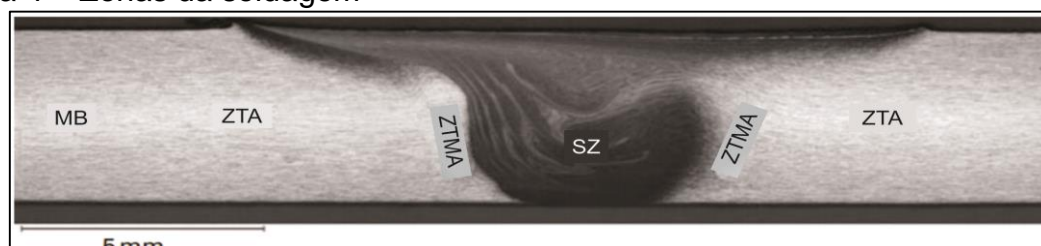
Figura 4 – Zonas da soldagem
