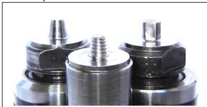
Figura 6 – Geometrias dos pinos das ferramentas
