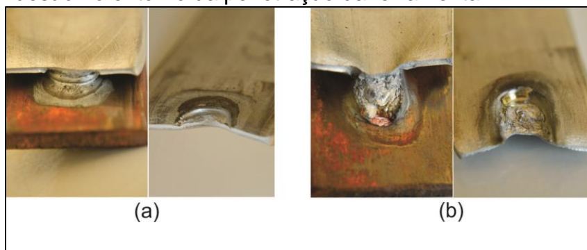
Figura 36 – Adesão no entorno da penetração da ferramenta.
