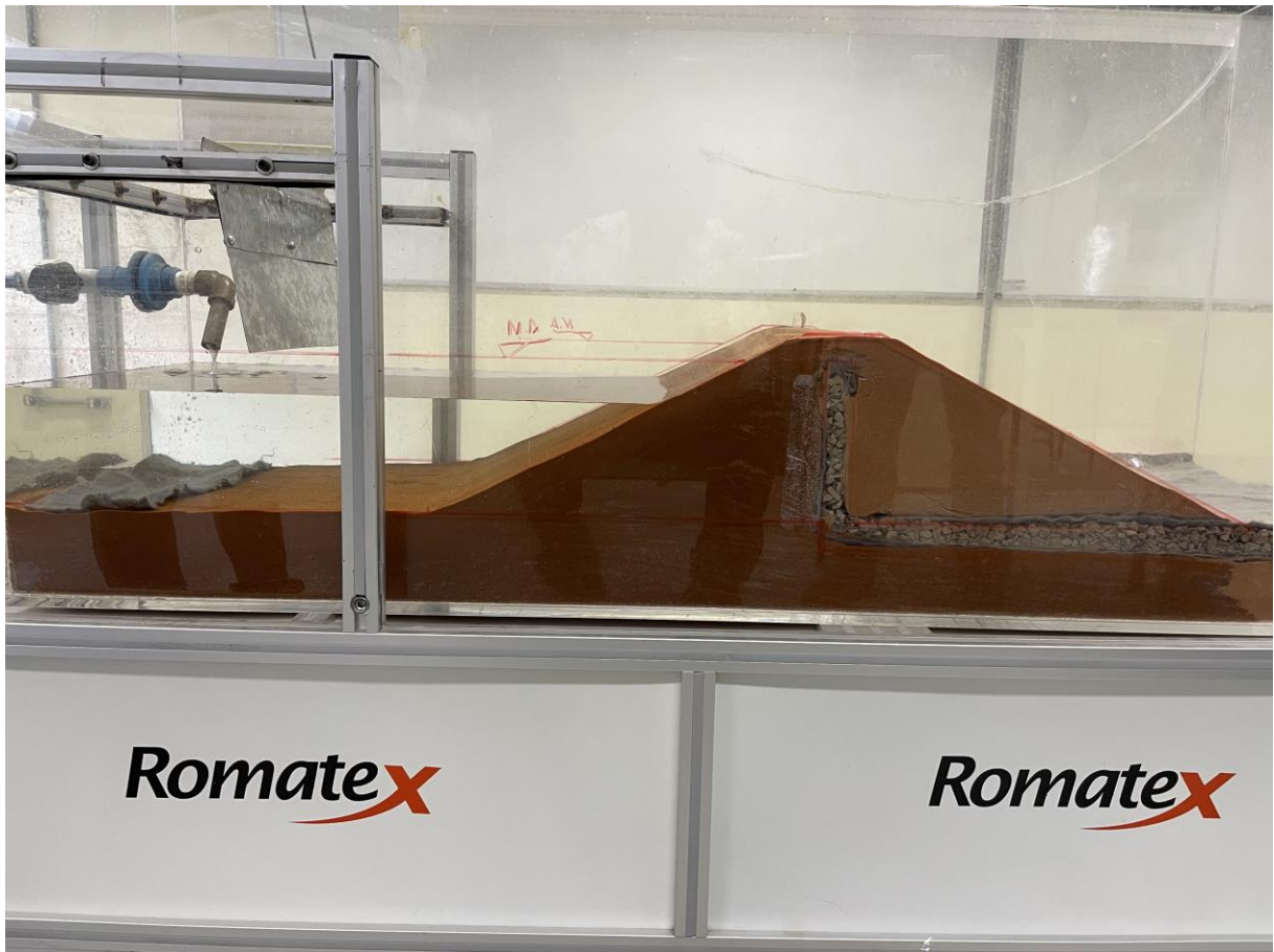
Figura 34: Filtro vertical e Filtro horizontal drenando o fluxo de água.
