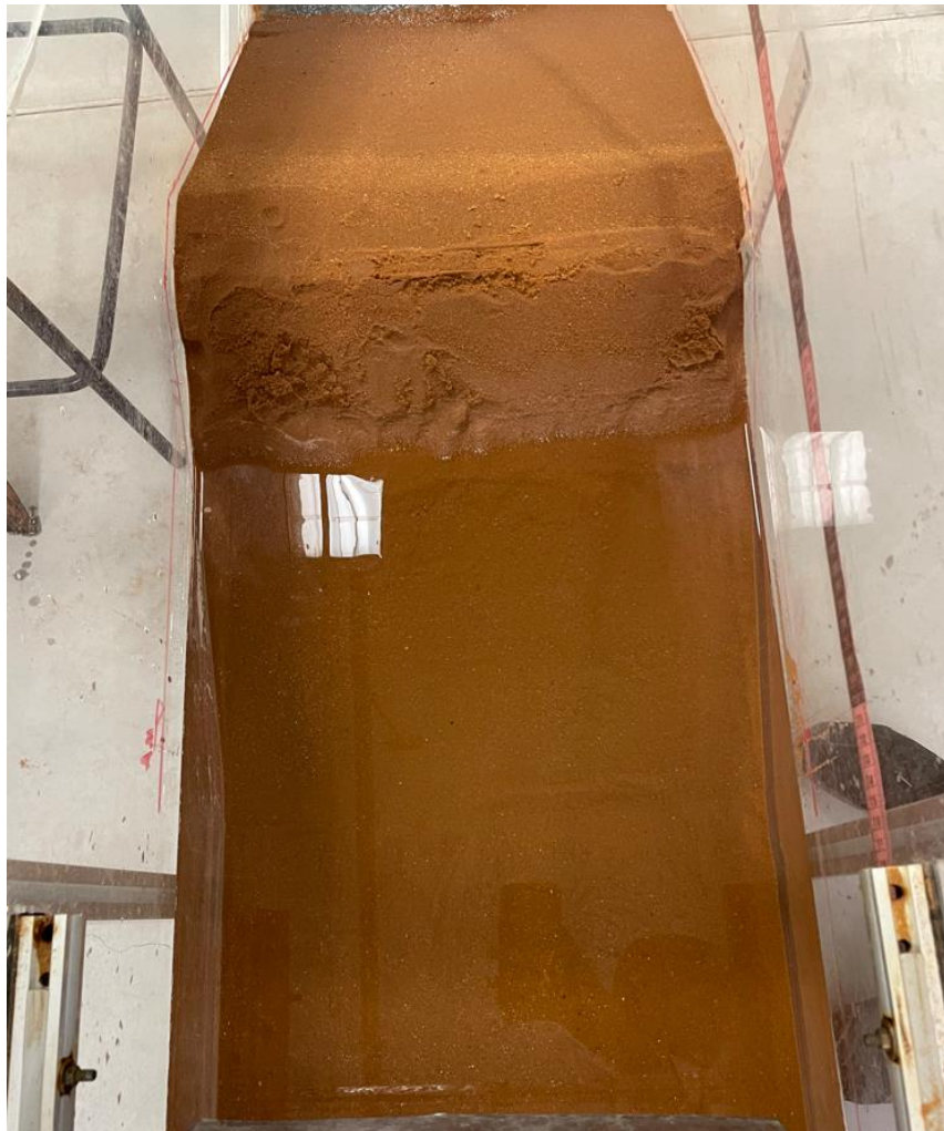
Figura 58: Remoção da geomembrana sobre o talude de montante.
