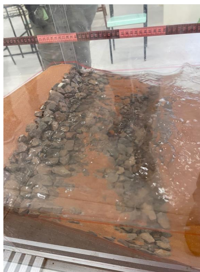
Figura 44: Remoção do material granular do talude de montante.
