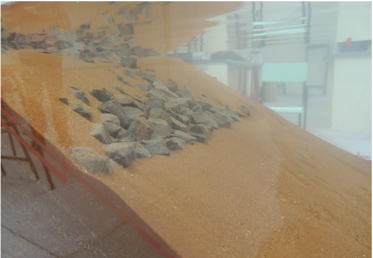
Figura 50: Aumento da remoção de material granular no talude de montante.
