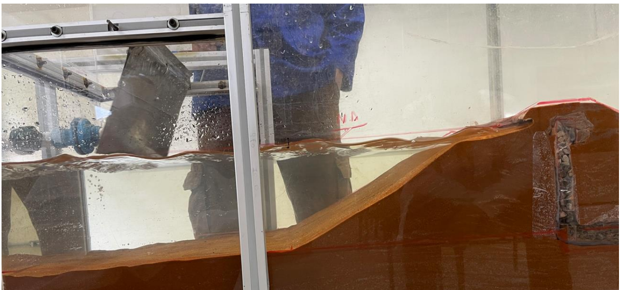
Figura 40: Erosão devido ao repuxo da onda.
