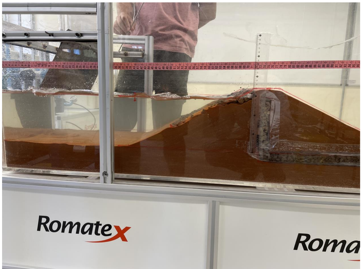
Figura 43: Erosão devido ao impacto da onda no talude de montante.
