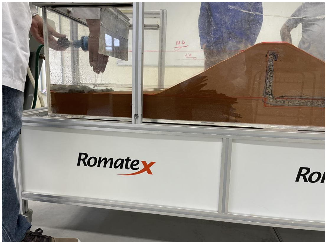
Figura 33: Efeito da capilaridade conforme aumentava nível de água.
