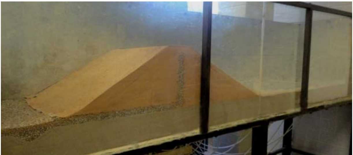
Figura 13: Exemplo de modelo físico reduzido de barragem de terra.
