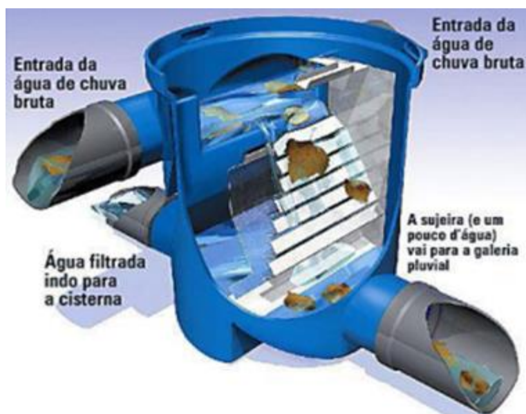
Figura 5 – Esquema de um filtro de água pluvial com descarte de sujeiras
