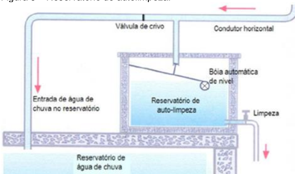
Figura 6 – Reservatório de autolimpeza.
