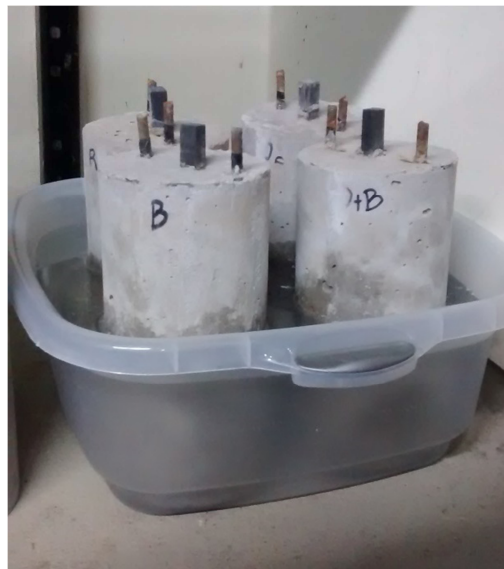
Figura 17: Corpo de prova parcialmente imerso em solução 3,5% NaCl.
