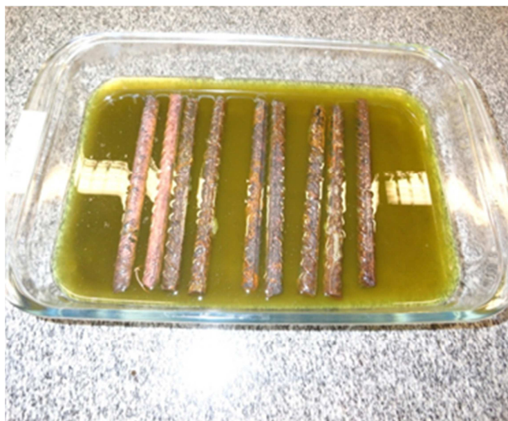
Figura 15: Imersão das barras em solução de limpeza.
