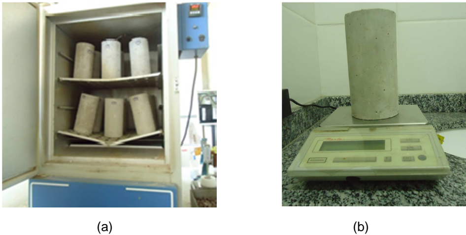
Figura 8: Secagem dos corpos de prova em estufa (a). Pesagem para verificação de constância de massa (b).
