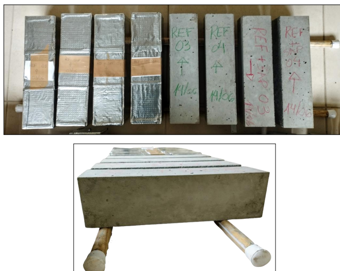
Figura 35 – Armazenamento dos corpos de prova sobre roletes
