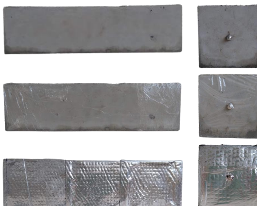
Figura 36 – Metodologia adotada para realizar a cura selada dos corpos de prova destinados ao ensaio de retração livre
