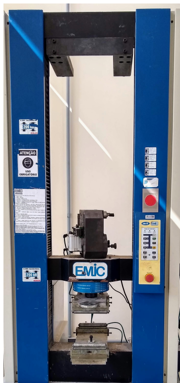
Figura 41 – Prensa hidráulica utilizada para realizar o ensaio de tração na flexão
