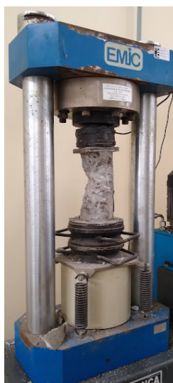
Figura 40 – Ensaio de compressão simples aplicado até a ruptura do espécime
