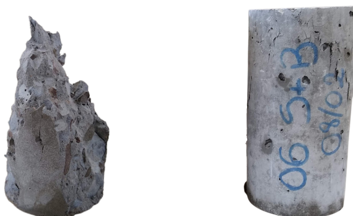
Figura 59 – Ruptura no formato cônico para espécimes sem fibra (esquerda) e com fibra (direita)
