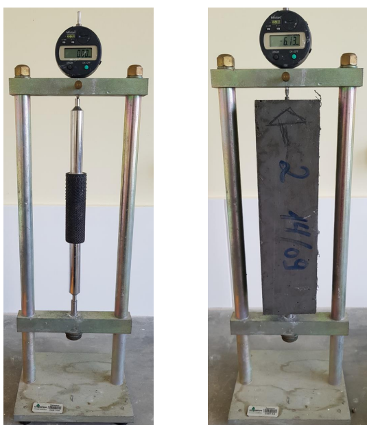
Figura 34 – Execução do ensaio de retração livre, calibração do equipamento (esquerda) e medição da variação dimensional (direita)
