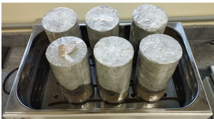
(a) Corpos de prova em contato com a lâmina de água de mm
