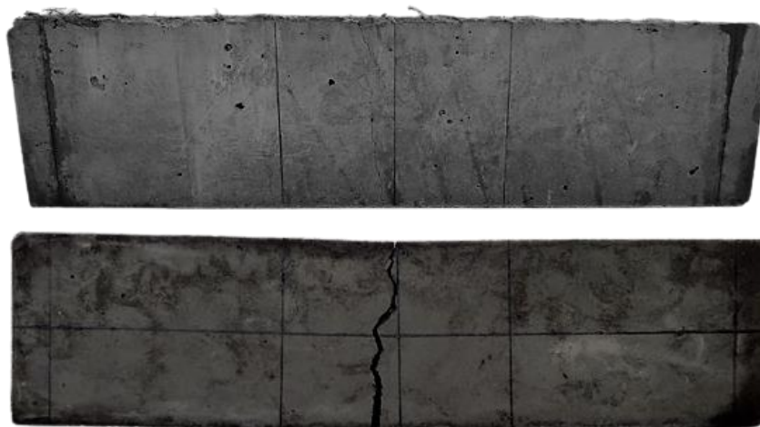
Figura 61 – Modo de ruptura dos espécimes durante o ensaio de tração na flexão; acima espécime com fibra e abaixo sem fibra
