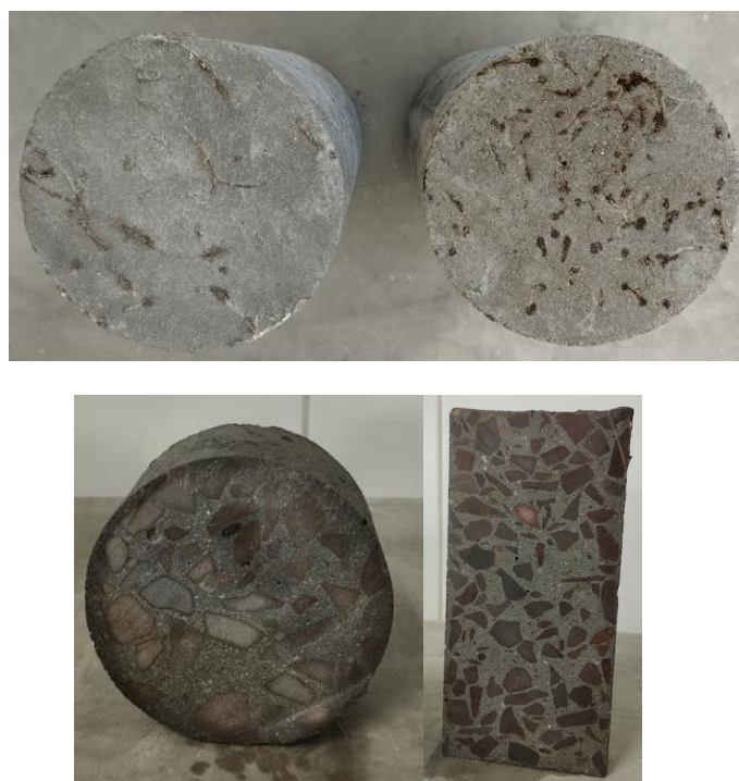
Figura 48 – Degradação da fibra a 105 °C na parte externa (acima) e interna (abaixo) dos espécimes
