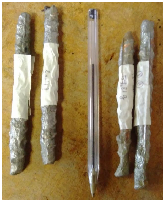
Figura 29 – Barras de aço do traço CCA25-AF75-AA após ensaio.
