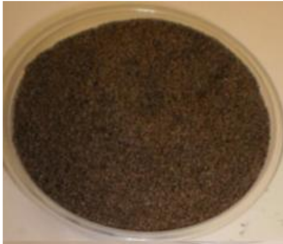
Figura 7 – Aspectos da textura e cor da amostra de areia de fundição fenólica
