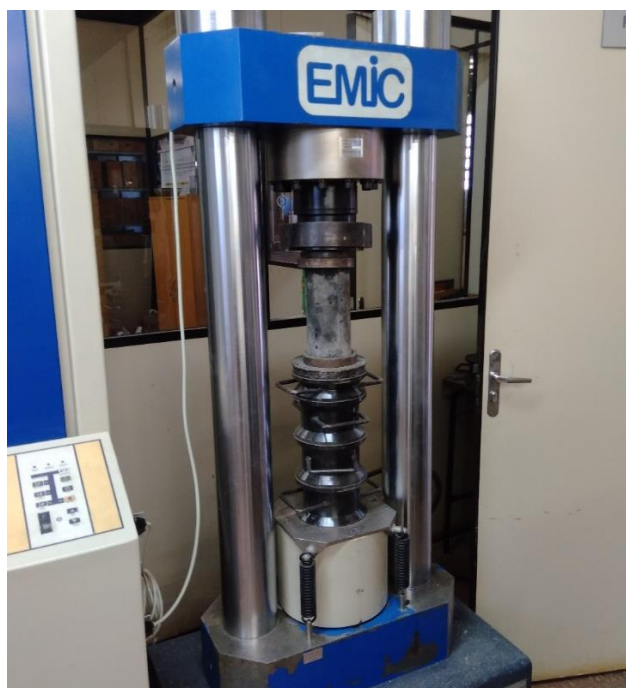
Figura 23 – Prensa para ensaio de resistência à compressão axial
