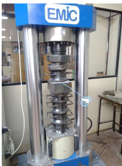
Figura 27 - Corpo de prova do ensaio de corrosão na prensa hidráulica.
