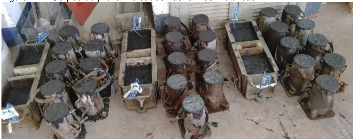
Figura 22 – Corpos de prova moldados nas formas metálicas
