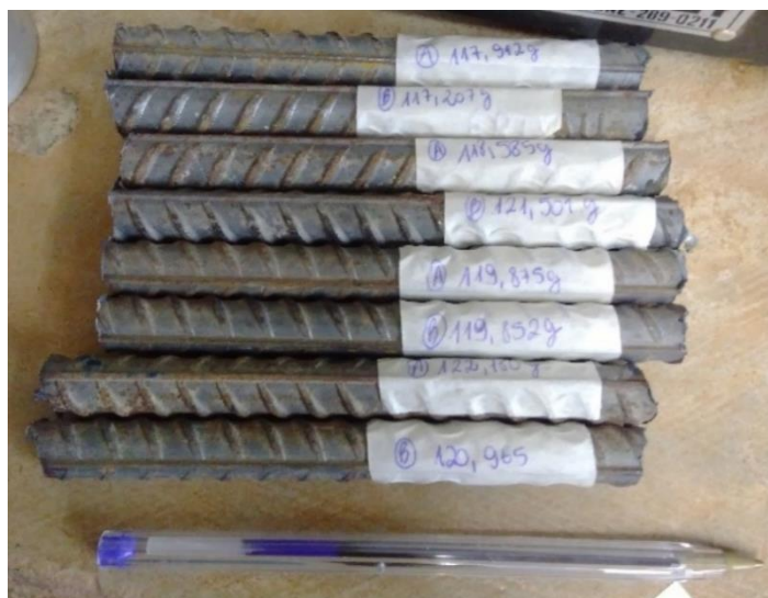
Figura 25 – Barras de aço para ensaio de corrosão CAIM
