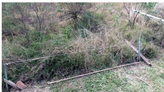
Figura 52 – Local com sombra - Medição manual com régua da altura da vegetação nativa no local de sensoriamento (Unipampa - Bagé, RS)
