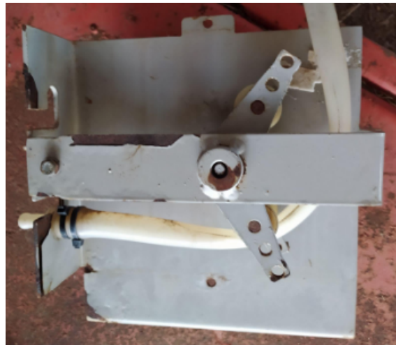
Figura 65 – Posição da mangueira (deformada) na bomba e o local de pressão pelo rolete. O sistema foi montado na terceira regulagem (furo interior)
