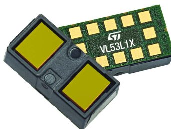
Figura 7 – Módulo integrado para medir distância VL53L1X, baseado em laser Classe 1, faixa de 940 nm
