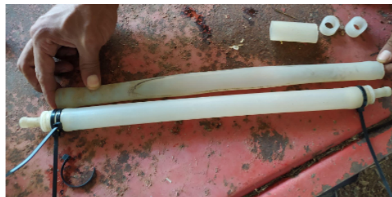
Figura 66 – Mangueira com o comprimento reduzido em comparação com a mangueira original
