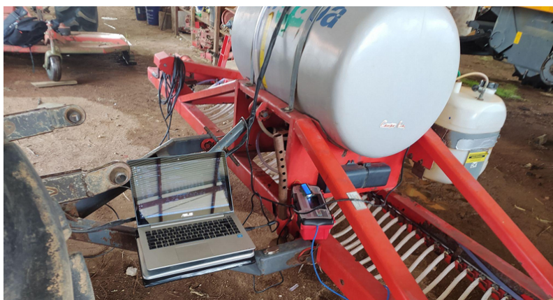
Figura 70 – Local dos experimentos de reparo e simulação com os dados de velocidade variável para calibração da vazão adequada
