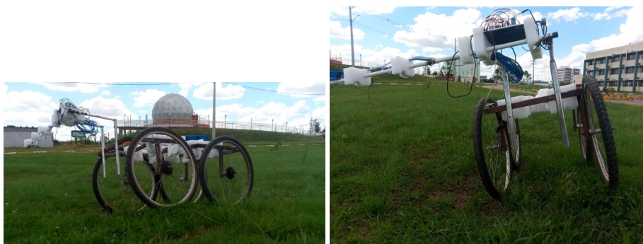
Figura 53 – Exemplo de alteração da altura da barra de sensores por variação do solo, onde uma irregularidade alterou em 20 cm a altura da extremidade da barra
