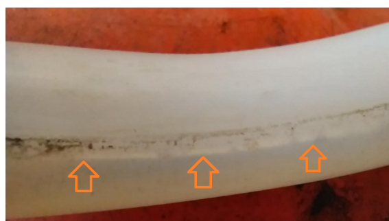
Figura 67 – Dano interno na mangueira original abaixo da marca do rolete. É observável devido a transparência da mangueira e destacado pelas setas
